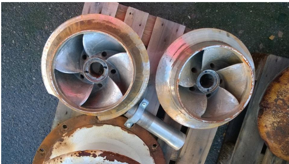
Kuva 14. Pumpun VE307 vaurioituneet juoksupyörät.
