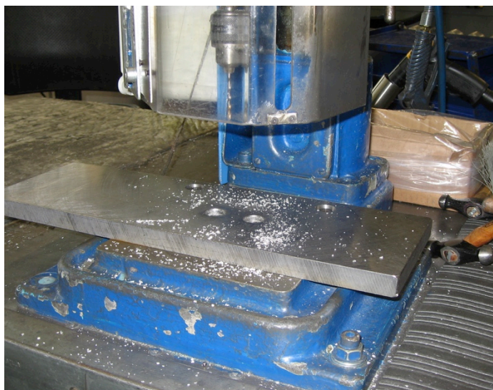
Kuva 6.9. Poraus- ja kuulauspiste ja siinä esiintyvät epäpuhtaudet.
