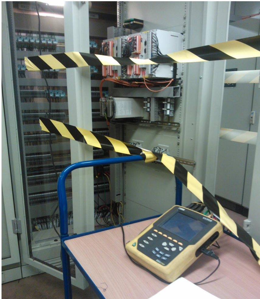
Kuva 15. Kannettava mittalaite QualiStar CA 8334 kytkettynä PM6:n magnetoitimi- tauksia varten.
