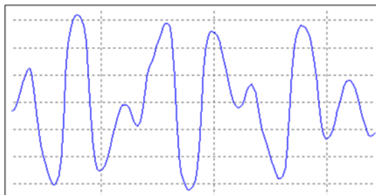
Kuva 13. Puolijaksollisen ferroresonanssin (Quasi-Periodic Ferreresonance) muodostaman ylijännitteen periaatteellinen käyrämuoto. [15]
