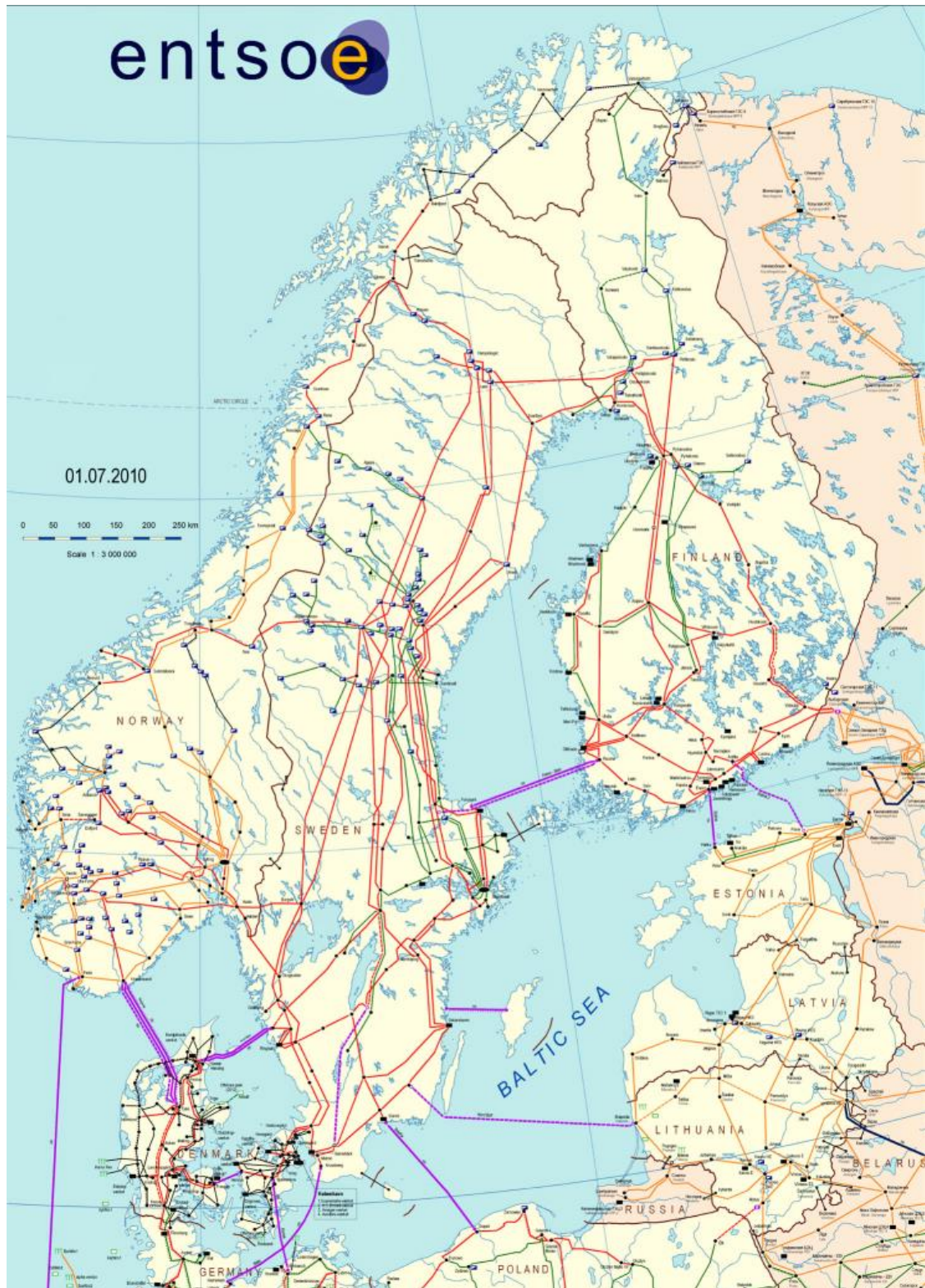
Kuva A.1. Pohjoismaisen voimajärjestelmän kartta vuodelta 2010 [14]. Rakenteilla oleviksi merkityt Fennoskan 2 ja Estlink 2 -tasasähköyhteydet sekä 400 kV:n johdot Suomessa ovat valmistuneet.
