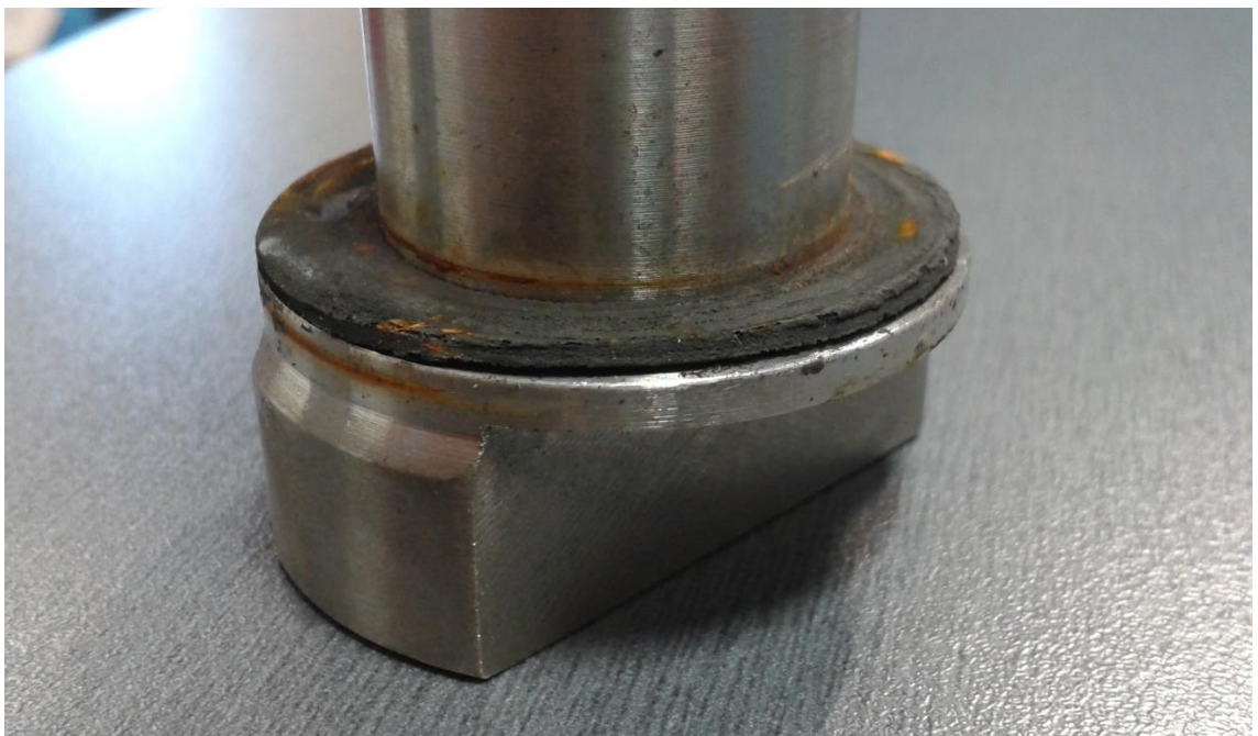
Kuva 2. DN125 kara ja liukulevy karaholkin hitsauksen jälkeen.
