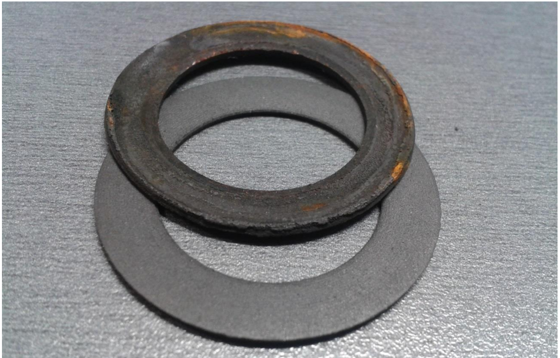
Kuva 1. Päällä hitsauksessa mukana ollut liukulevy ja alla uusi liukulevy.
