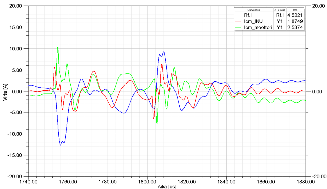
Kuva 6.8: Simuloidut i_{CM,INU} , i_{CM,Moottori} ja i_{Vikavirta} ajan funktiona 250 metrin moottori-kaapelilla, kun kaapelin moottoripäässä on maasulku. staattorin hajakapasitanssin arvona on käytetty arvoa C_{ws} * 1,5 .
