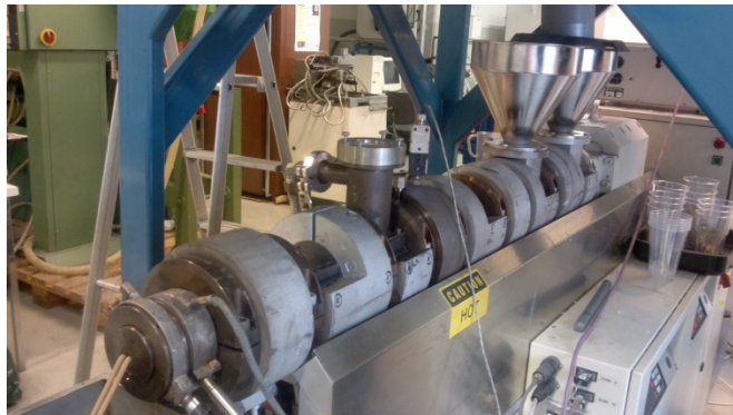
Kuva 3.1. Materiaalien kompaundoinnissa käytetty kaksiruuviekstruuder
