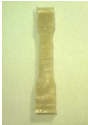
Kuva 4.8. Viisi tilavuusprosenttia sellua sisältävä orientaatiotutkimuksen vetokokeita varten työstetty polyeteenikappale
