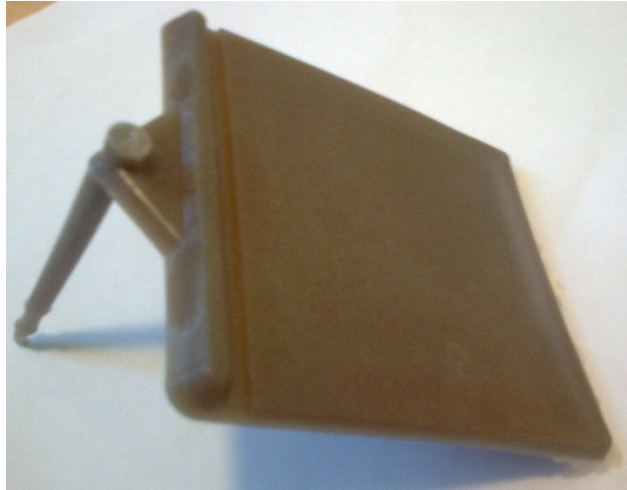
Kuva 4.7. Viisi tilavuusprosenttia pellavaa sisältävä orientaatiotutkimuksia varten ruiskuvalettu polyeteenikappale
