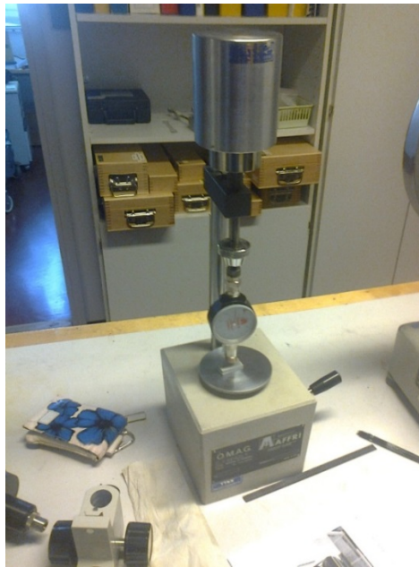
Kuva 6.4. Kovuuskokeessa käytetty laite
