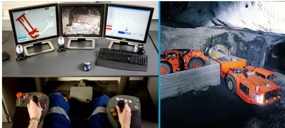
Kuva 2.2 Sandvik AutoMine-järjestelmä mahdollistaa maanalaisten kaivoslaitteiden operoimisen maan pinnalla sijaitsevasta valvomosta (Sandvik, 2013)
