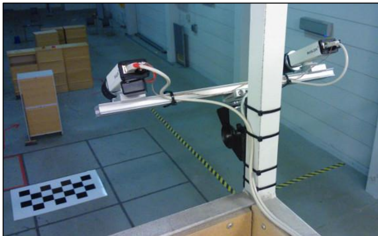
Kuva 5.3 Kiinteästi huoltotason kaiteeseen asennettu hallikamera antaa toiminta-alueesta hyvän yleiskuvan
