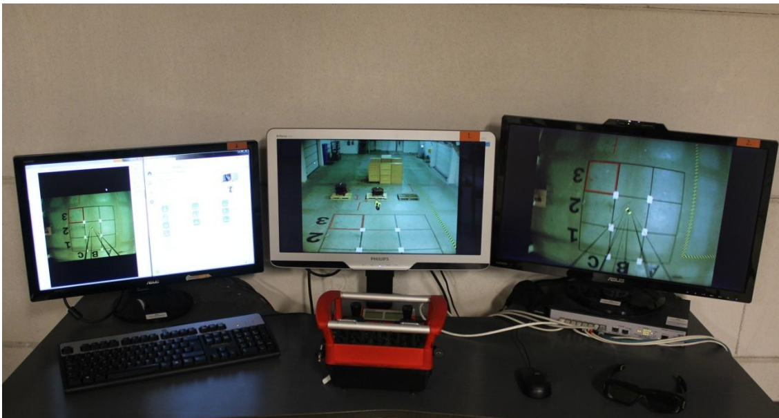
5.2 Testijärjestelmän teleoperointiasema: Vasemmalla 2D-näyttö, keskellä Autostereoskooppinen näyttö, ja oikealla suljintekniikalla toteutettu 3D-näyttö
