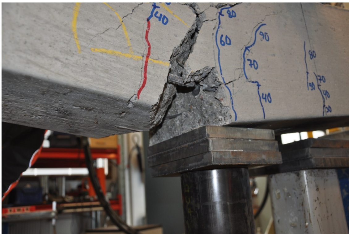
Kuva L2.6 Poikki menneet pääteräket kalliokärjen tartuntaterästen päättymiskohdassa
