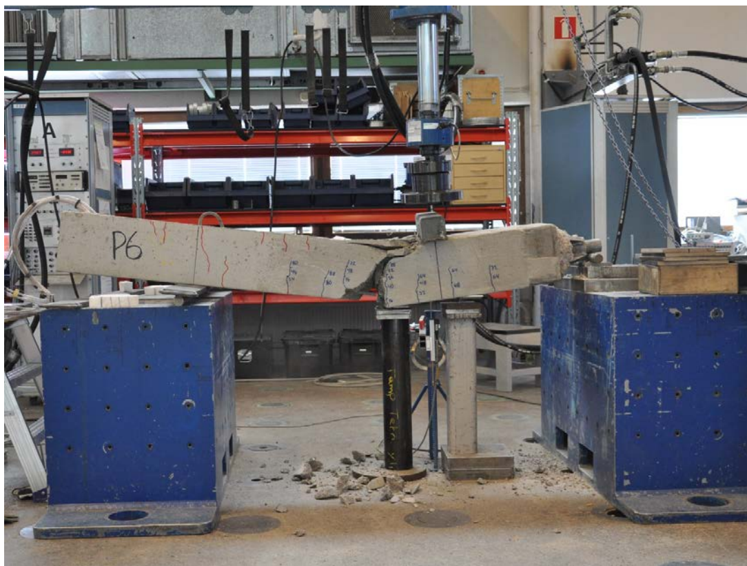
Kuva 4.17 Paalun 250a murtumistapa oli taivutusmurto. Paalun pääteräkset menivät poikki kalliokärjen ankkurointiterästen päättymiskohdassa.
