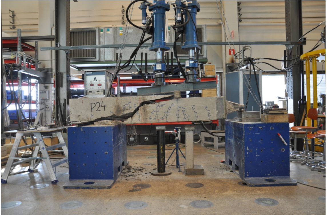
Kuva L2.12 Paalun 350a murtumistapa oli paalun varren leikkausmurto
