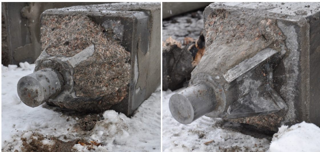
Kuva 4.12 Kalliokärjissä 250b ja 250a ei lyöntikokeiden jälkeen ollut havaittavissa merkittäviä vaurioita.
