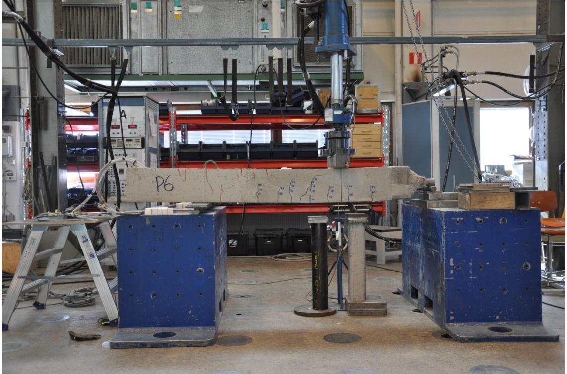
Kuva L2.1 Taivutuskoejärjestelyt ja paalun halkeamat juuri ennen murtoa
