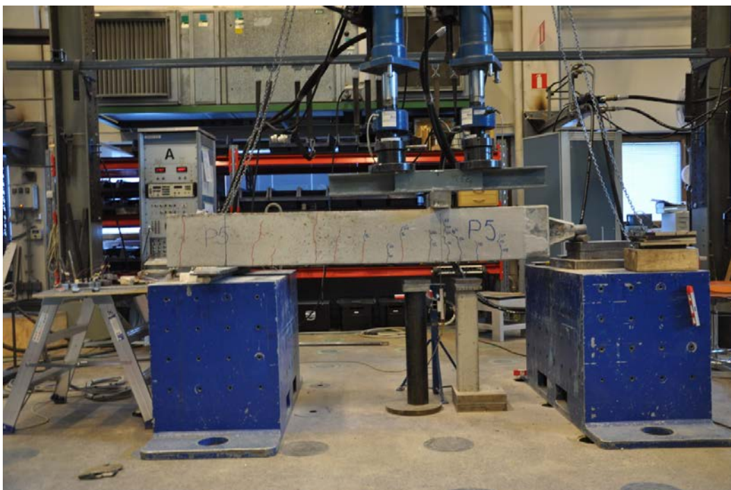
Kuva L2.7 Koejärjestelyt ja betonin halkeamat
