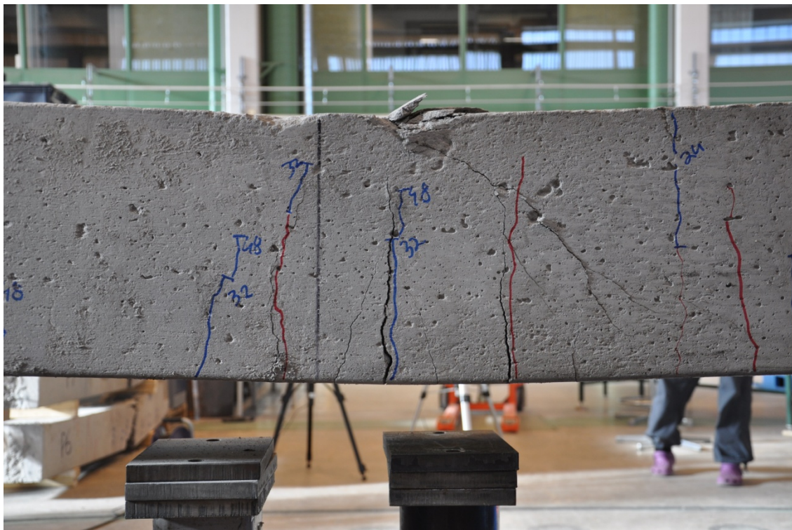
Kuva L2.8 Paalun 300b murtumistapa oli yhdistetty taivutusleikkausmurto
