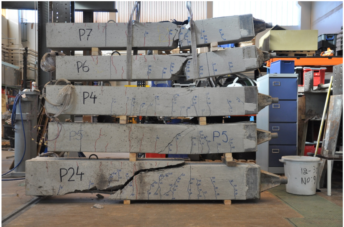
Kuva L2.14 Yhteiskuva taivutuskuormitetuista paaluista.
