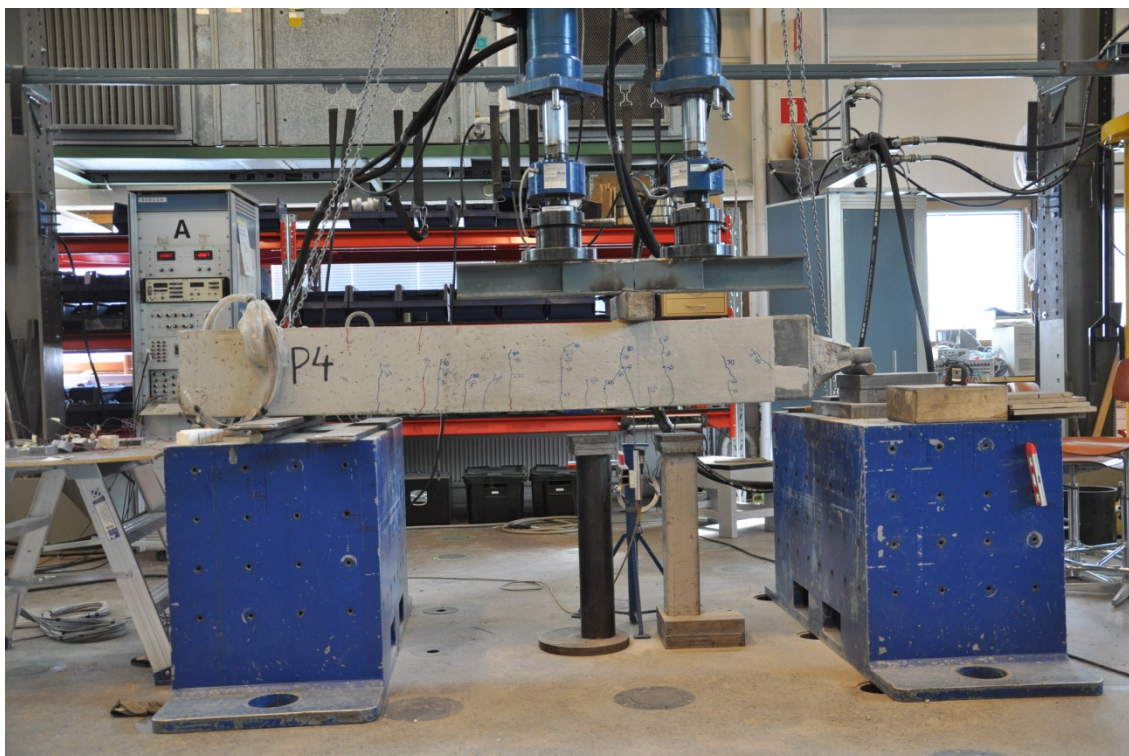
Kuva L2.9 Koejärjestelyt ja betonin halkeamat kuormituksessa
