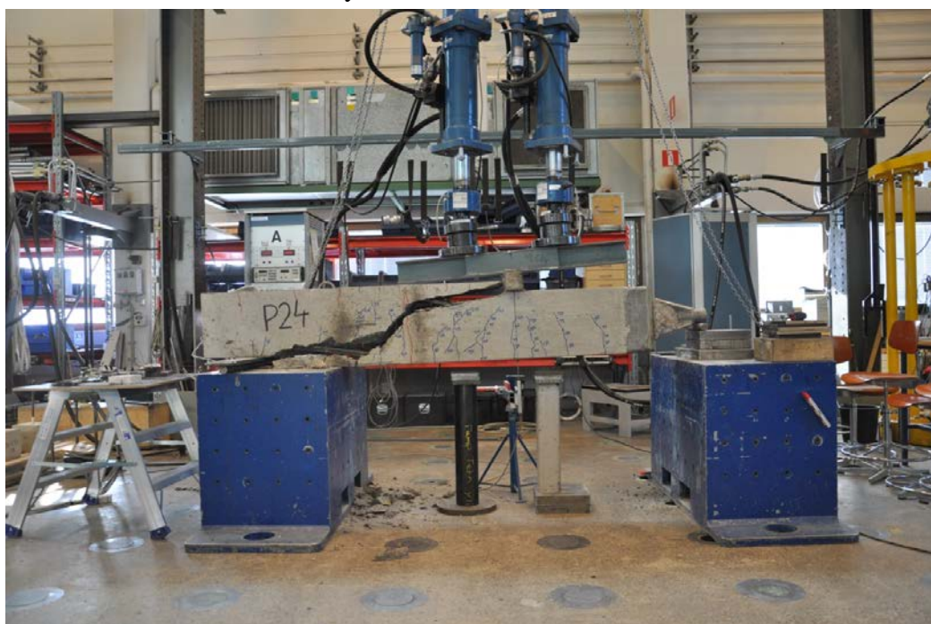
Kuva 4.33 Paalun 350a murtumistapa oli paalun varren leikkausmurto
