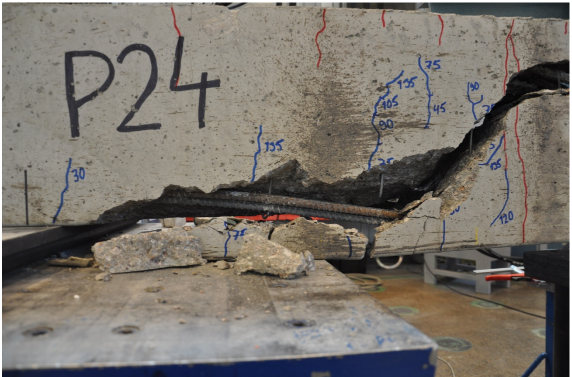
Kuva L2.13 Paalun haat ovat menneet poikki murren yhteydessä
