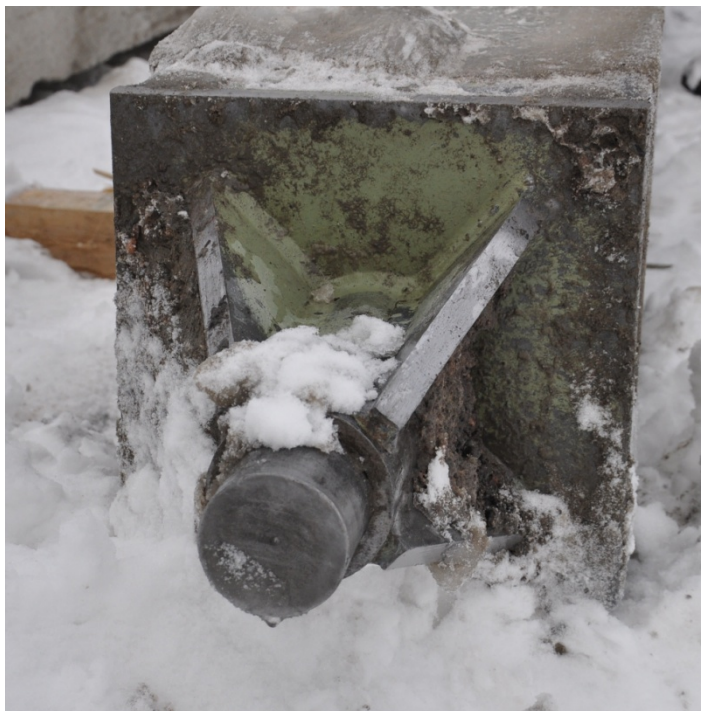
Kuva 4.13 Kalliokärki 350a ei vaurioitunut lyöntikokeessa.
