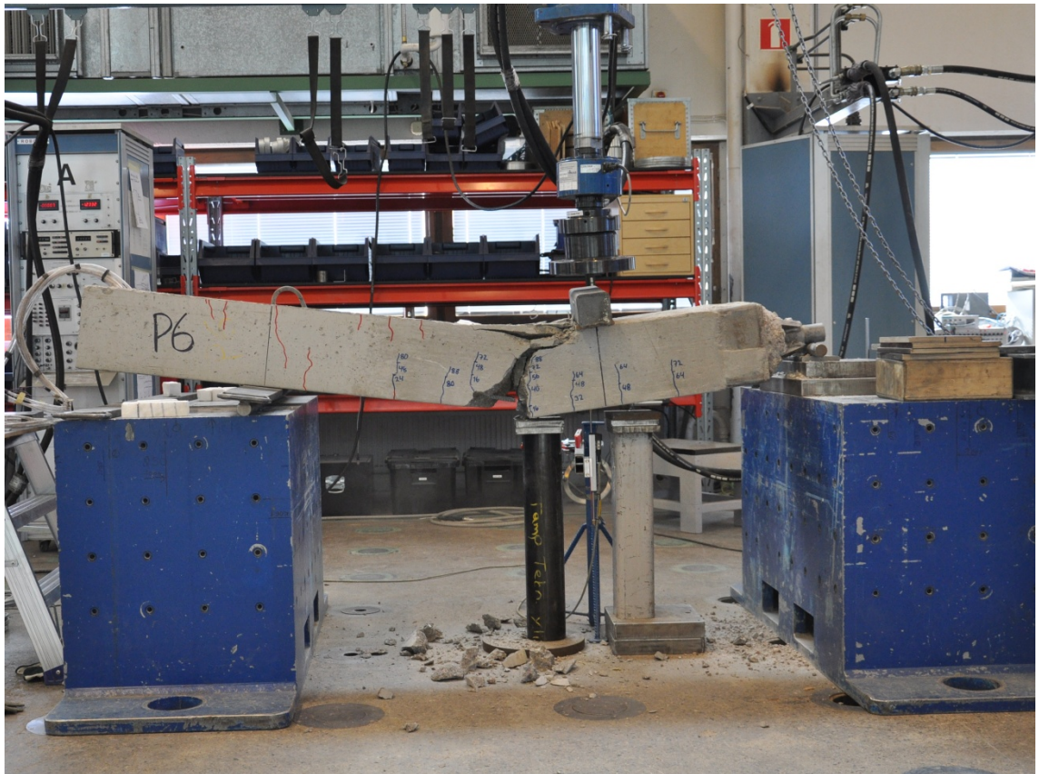
Kuva L2.2 Paalun 250a murtumistapa oli taivutusmurto
