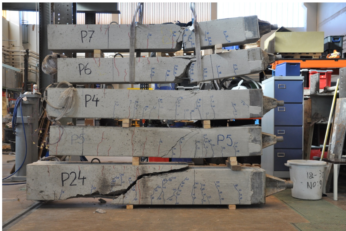
Kuva 4.15 Testatut paalut taivutuskokeen jälkeen. Paalujen P7 ja P6 murtumistapa oli paalun varren taivutusmurto kalliokärjen tartuntaterästen päättymiskohdassa. Paalujen P4 ja P5 murtumistapa oli yhdistetty paalun varren taivutusleikkausmurto kuormapisteen kohdassa. Paalun P24 murtumistapa oli paalun varren leikkausmurto.
