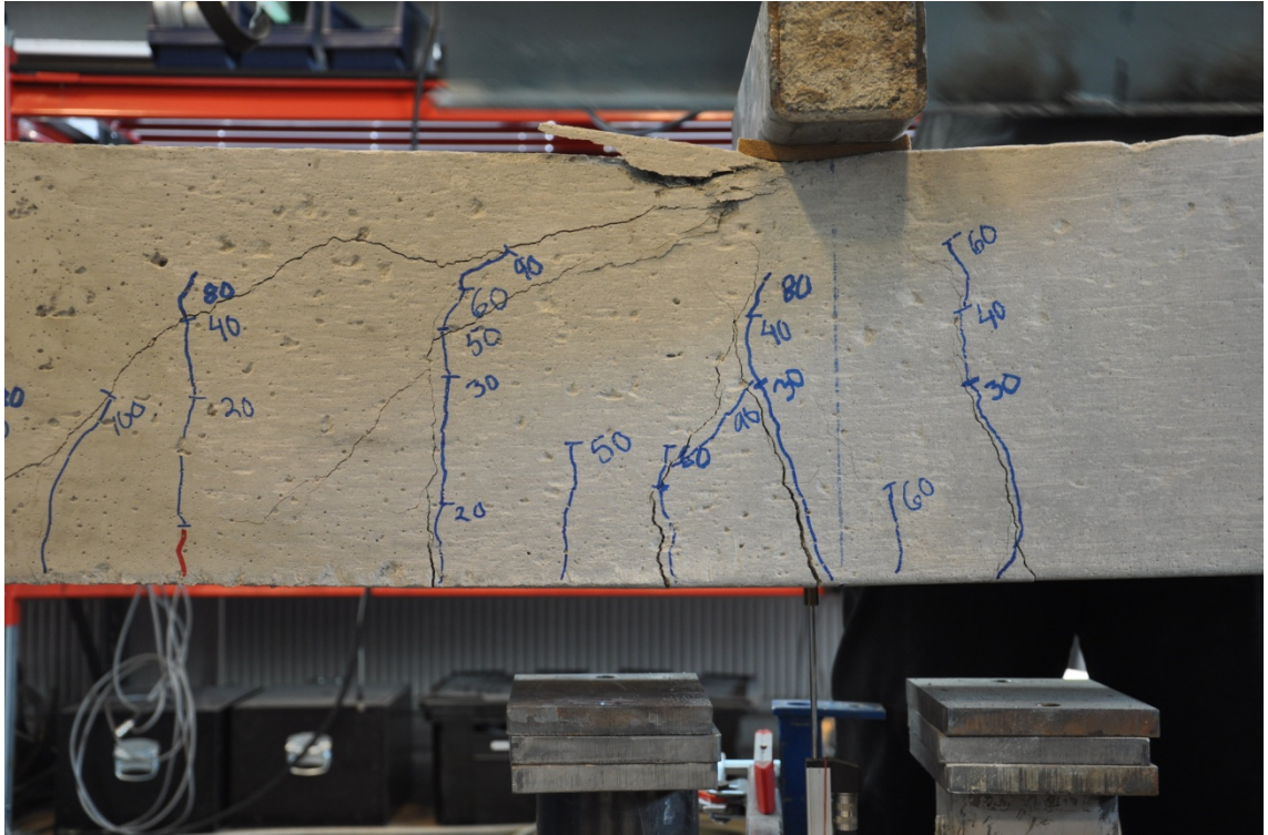
Kuva L2.10 Paalun 300c murtumistapana oli paalun varren yhdistetty taipuma-leikkausmurto
