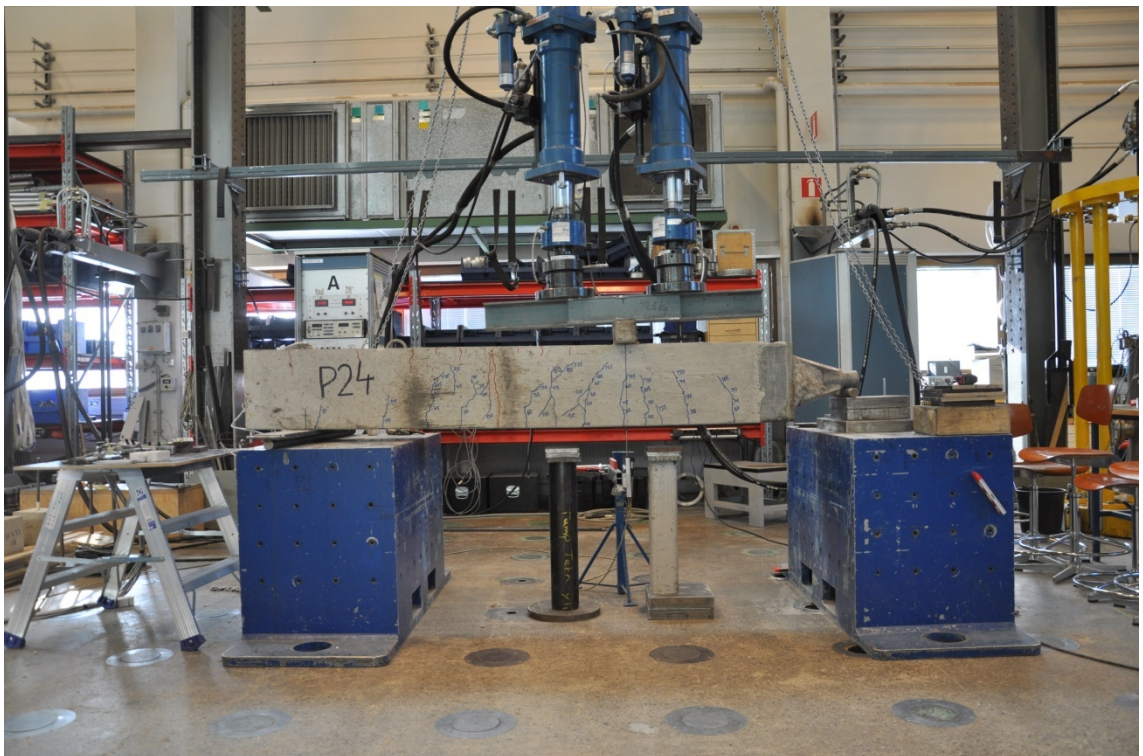
Kuva L2.11 Koejärjestelyt ja paalun 350a halkeamat
