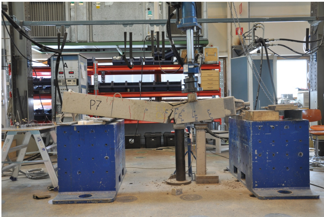
Kuva 4.21 Paalun 250b murtumistapa oli taivutusmurto. Paalun pääteräkset menivät poikki kalliokärjen ankkurointiterästen päättymiskohdassa.
