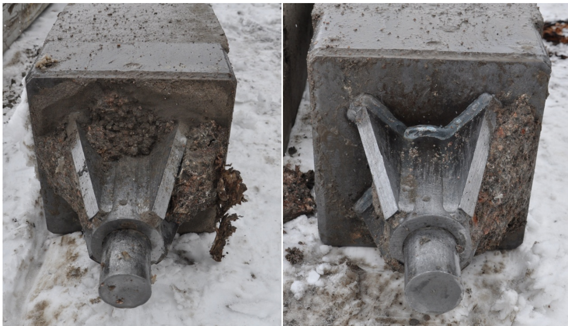
Kuva 4.11 Kalliokärjissä 300c ja 300b ei lyöntikokeen jälkeen ollut havaittavissa merkittäviä vaurioita.
