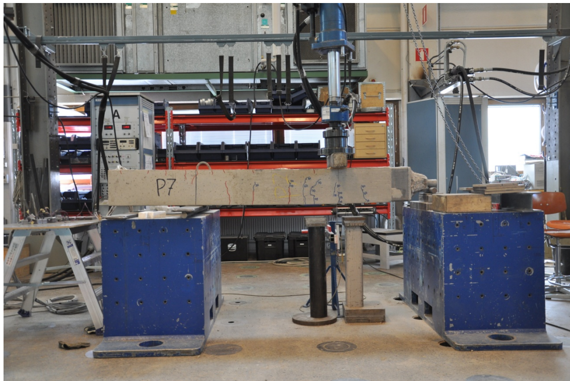
Kuva L2.4 Koejärjestelyt ja koekappaleen halkeamat
