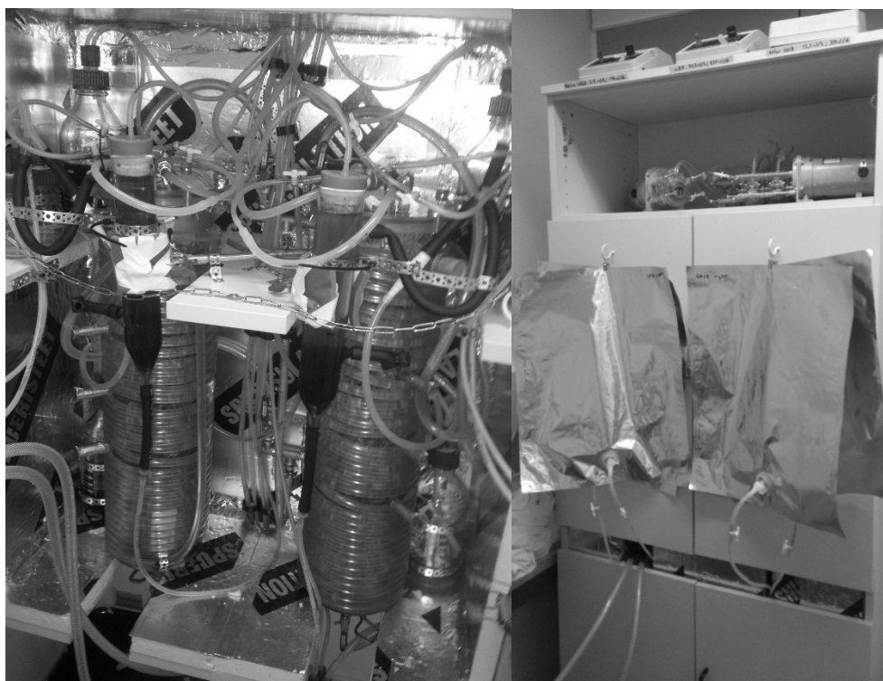
Kuva 15 Kokeessa käytettiin kahta identtistä LBR-UASB yhdistelmäreaktoria (vasemmalla) jotka oli sijoitettu lämpöeristettyyn reaktorikaappiin ja oikealla on reaktorikaappi suljettuna. (Kuva, Alatalo 2013)
