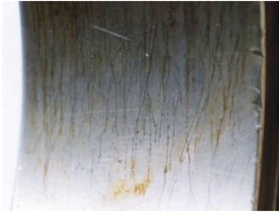
Kuva 12. Spark track eli kipinäuravaurio liukulaakerin liukupinnalla (Sohreturbo).
