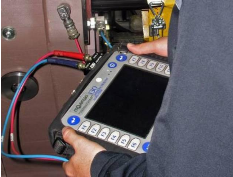
Kuva 22. CSI 2130 kaksikanavainen värähtelyanalyysaattori (Moventas Gears).
