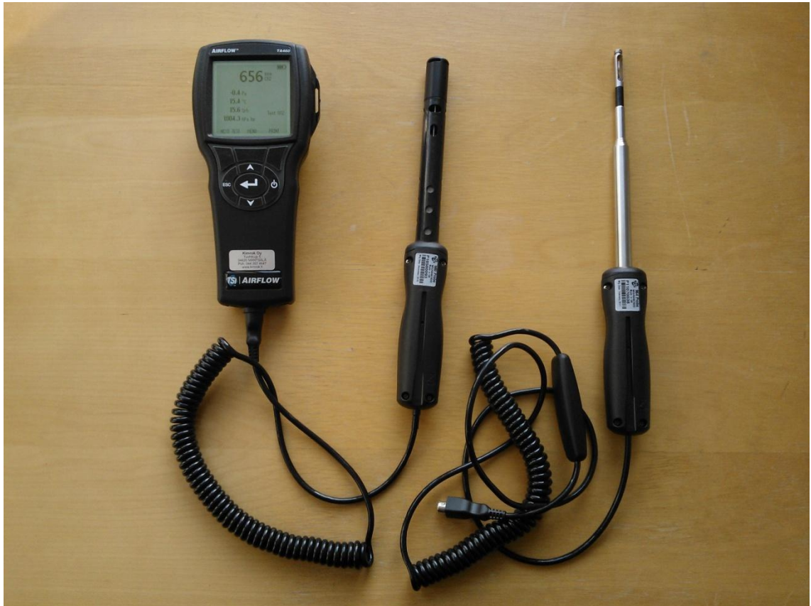
Kuva 4.5. Kalibroinnissa ja mittausten tukena käytetty käsimittari TSI Airflow TA460 ja sen kaksi mittauspäätä. Ilmavirran nopeuden mittaamiseen 964 Probe ja hiilidioksidipitoisuuden, lämpötilan sekä suhteellisen kosteuden mittaamiseen 980 Probe.
