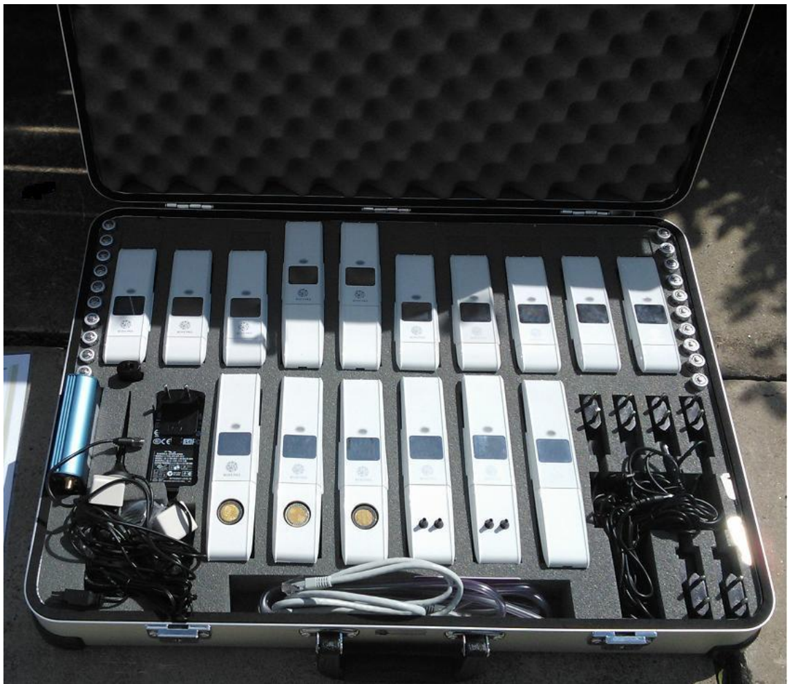
Kuva 4.3. Tutkimuksissa sisäilman suureiden mittaamiseen käytetty Wirepasin mittaus- ja tiedonkeruujärjestelmä kantosalkkunaan.
