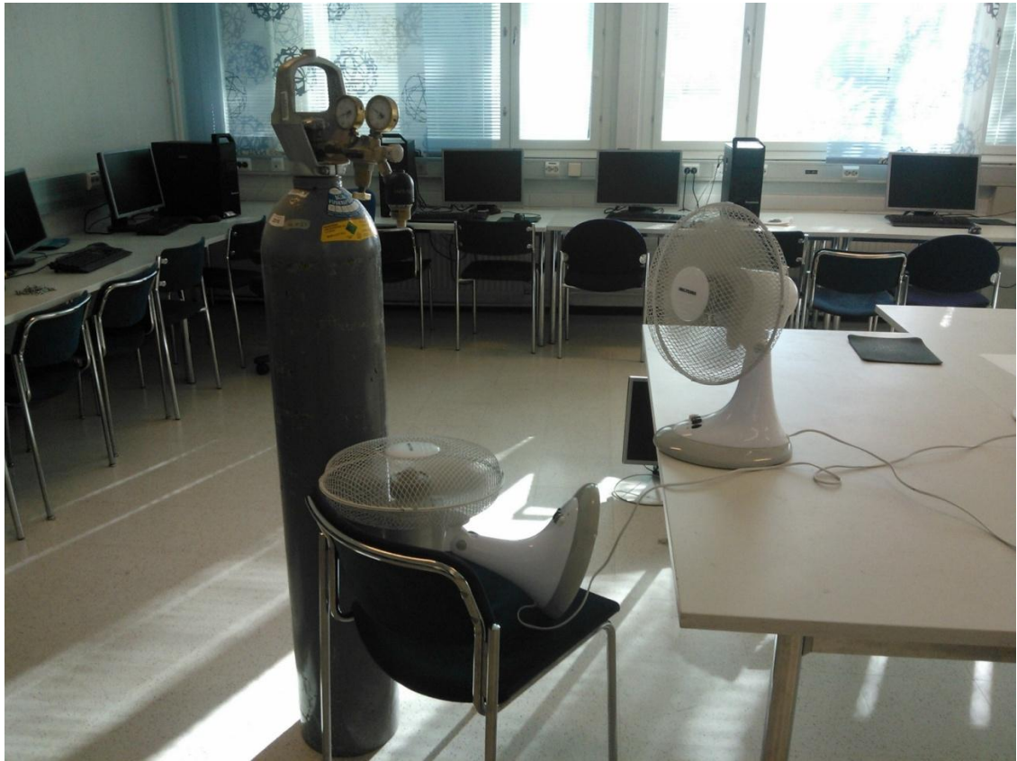
Kuva 4.10. Luokkaan K1243 laskettiin synteettistä hiilidioksidia ja ilmaa sekoitettiin tuulettimin niin kauan, että tietty pitoisuus saavutettiin tasaisesti koko luokassa.
