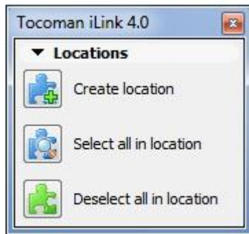
Kuva 3.8: iLinkin sijaintiprisma-työkalu, jolla rakennuskohde voidaan esimerkiksi lohkoittaa.
