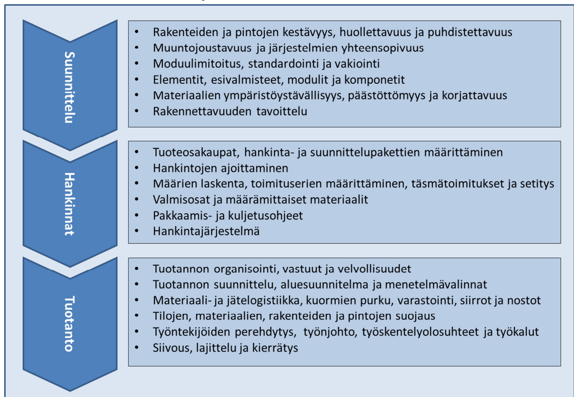
Kuva 5.1 Materiaalitehokkuuden parantamiskeinojen päänäkökohdat on jaettu kolmeen osaan: suunnitteluun, hankintoihin ja tuotantoon. Jokaisessa vaiheessa on omat merkitystekijänsä, mutta yhdistävänä tekijänä on hyvä materiaalien hallinta.
