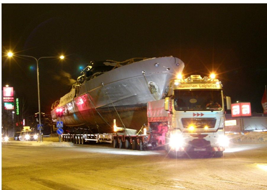
Kuva 8. Esimerkki hyvin suuresta kuljetuksesta tieverkolla: Vartiovene 55 siirrettiin Näsijärveltä Itämerelle tammikuussa 2012. Tiekuljetus tapahtui Tampereelta pääasiassa valtatieä 11 pitkin Poriin, mistä alus jatkoi matkaansa meritse Helsinkiin (kuva: Kimmo Heikkilä 2012).
