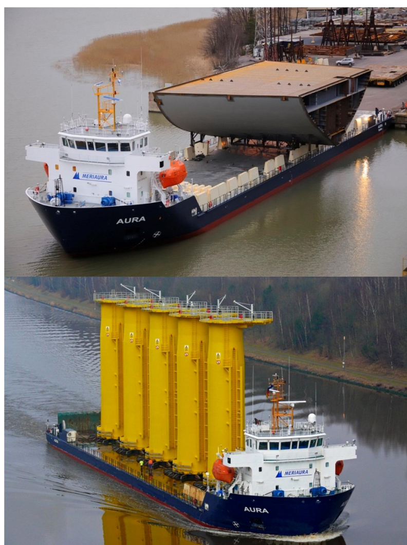
Kuva 9. Kaksi esimerkkiä kuljetuksista, joiden toteutus muuta reittiä kuin vesitse ei olisi ollut mahdollista. Ylemmässä kuvassa kuljetettavana laivalohko nykyisen STX Finland Oy:n telakalle Turkuun, alemmassa massiivisia komponentteja vietävänä Englannin länsirannikolle Walney 2 -tuulivoimapuiston rakennustyömaalle. Aura-alus rakennettiin erityisesti silloisen Aker Yardsin laivanosien kuljetustarpeita silmällä pitäen. Sitten alusta on kehitetty rannikon edustalle sijoitettujen tuulivoimapuistojen rakennusvaiheen kuljetuksiin. (Turun Sanomat 2008; Meriaura 2012.) Kuvat: Meriaura Oy 2008, 2011.
