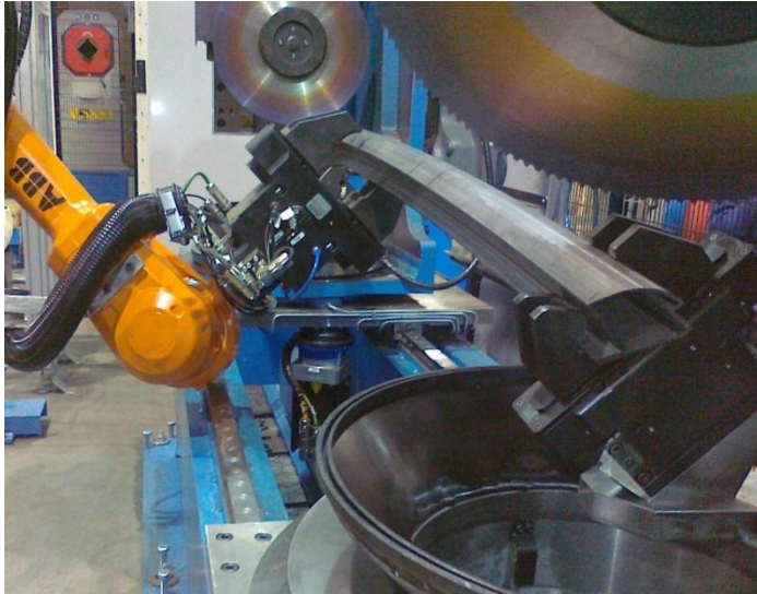
Kuva 12. Robotin tarttuja ja sahan kiinnittimet
