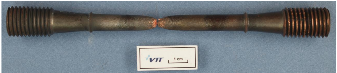
Kokeessa y359 murtunut koesauva.
