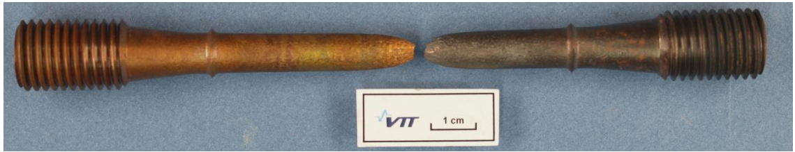
Kokeessa y357 murtunut koesauva.
