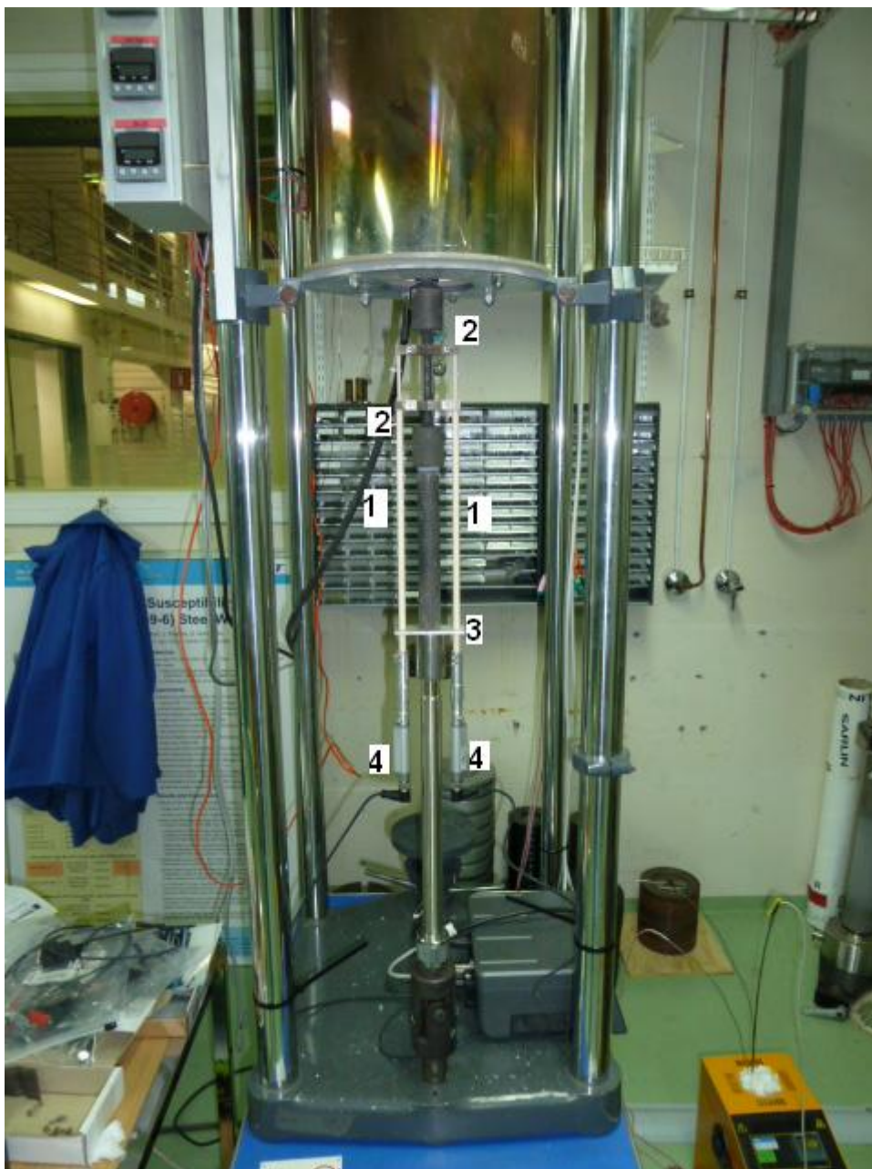
Kuva 7.11: Virumiskokeissa käytetyt keraamiset jatkovarret (1) venymäantureille. Muut numeroidut osat ovat koesauvan olakkeisiin kiinnitettävät lisäosat, joita vasten anturien jatkovarret liikkuvat (2), jatkovarsien tukilevy (3) ja venymäanturit (4).
