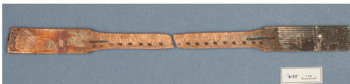
Kuva 7.7: Vetokokeessa murtunut koesauva.
