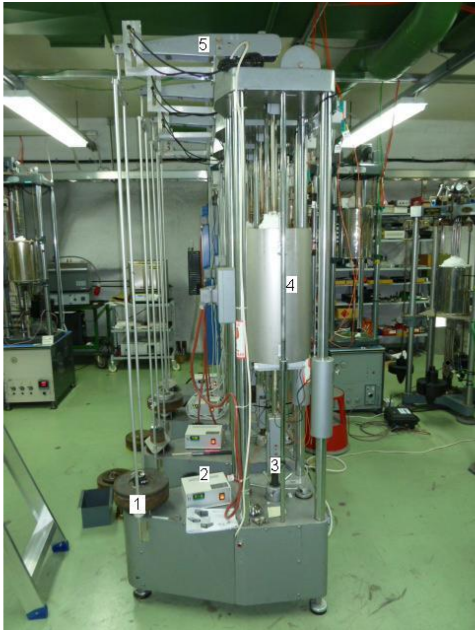
Kuva 7.9: Vakiokuormituksellinen virumiskone. Virumiskoneen oleellimmat elementit ovat 1) painot, 2) lämmitysyksikkö, 3) pystysuunnassa liikkuva kierretanko, 4) uuni ja 5) vipuvarsi. Kuvasta puuttuu tietokone, johon antureilta saatu data tallentuu.
