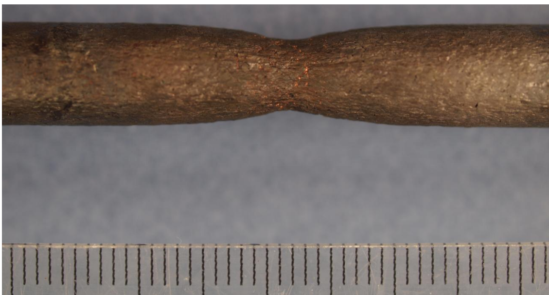
Kuva 8.11: Kokeen y362 murtumaton koesauvan kuroutunut kohta. Alhaalla näkyvän mittajan yksikkö on yksi millimetri.
