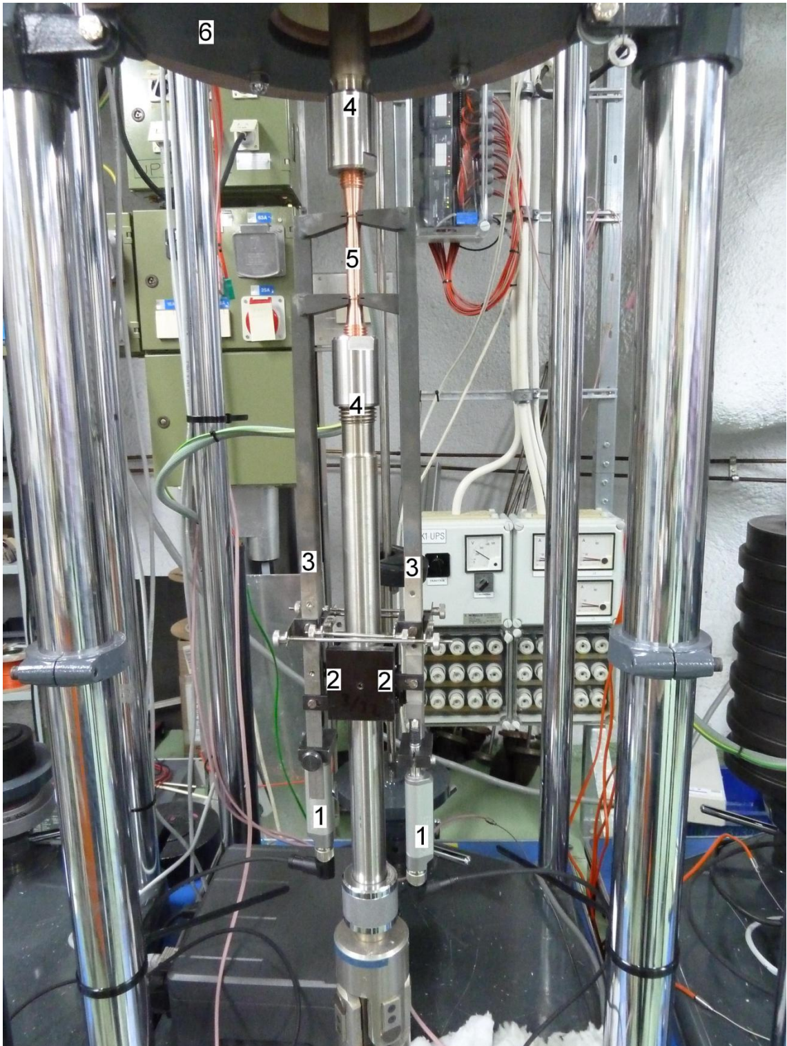
Kuva 7.10: Koesauvan ja venymäanturien kiinnitys virumiskoneeseen. Kuvaan on merkitty 1) venymäanturit, 2) tukipala, jota pitkin anturien jatkovarret pääsevät liikkumaan, 3) jatkovarret, 4) vetotanko, 5) koesauva ja 6) uuni.
