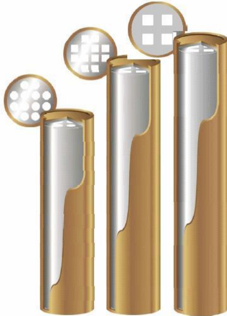
Kuva 2.2: Eri polttoaine tyypeille tarkoitetut loppusijoituskapselit. Vasemmalla VVER 440-tyyppinen, keskellä BWR-tyyppinen ja oikealla EPR-tyyppinen loppusijoituskapseli. [9, s. 22]
