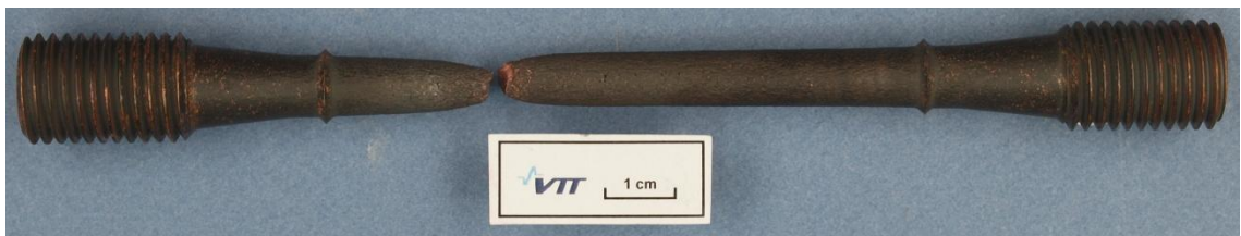
Kokeessa y358 murtunut koesauva.
