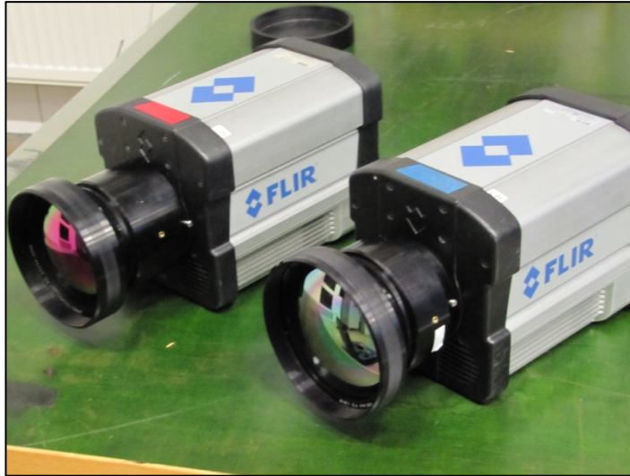
Kuva 2.2. Vasemmalla MW-lämpökamera ja oikealla LW-lämpökamera FL 100-linssein varustettuina.
