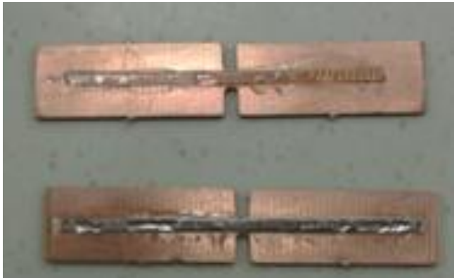
Kuva 4.3. Pinnoitettu ja pinnoittamaton koemateriaali koesauvoihin liimattuna.
