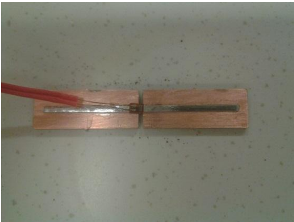
Kuva 4.1. Pinnoitettuun koemateriaalin kiinnitetty venymäliuska.
