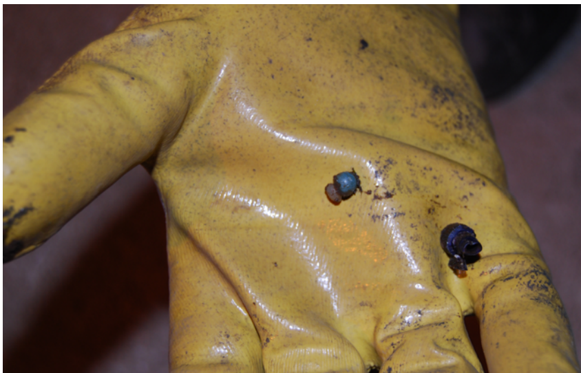
Kuva 42. Syklonin tukkeutumisen aiheuttanut esine.
