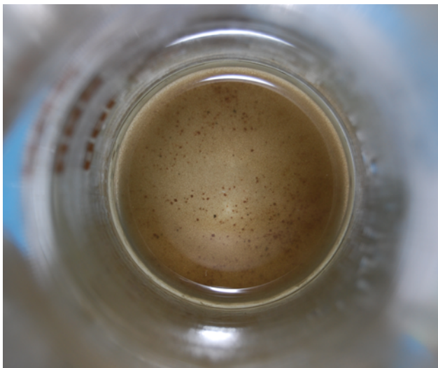
Kuva 47. Kiintoaineen poistamiseksi suoritettujen dekantointien aikana otettu näyte anammox-granuloiden määrän seuraamiseksi.
