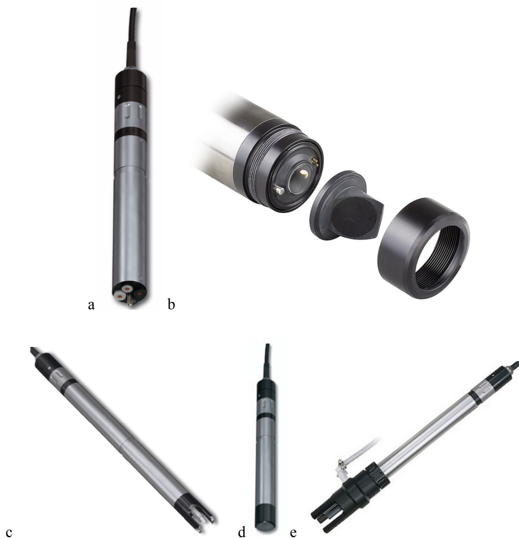
Kuva 29. Prosessissa käytetyt WTW:n mittarit, joista a) mittaa nitraattityppeä, b) liuen- nutta happea, c) pH:ta, d) johtokykyä ja e) ammoniumtyppipitoisuutta. Ammoniumtyp- pipitoisuuden mittauksessa on kuvassa kiinni myös paineilmapuhdistussuutin, joka oli käytössä myös Viikinmäen pilotointijaksolla.
