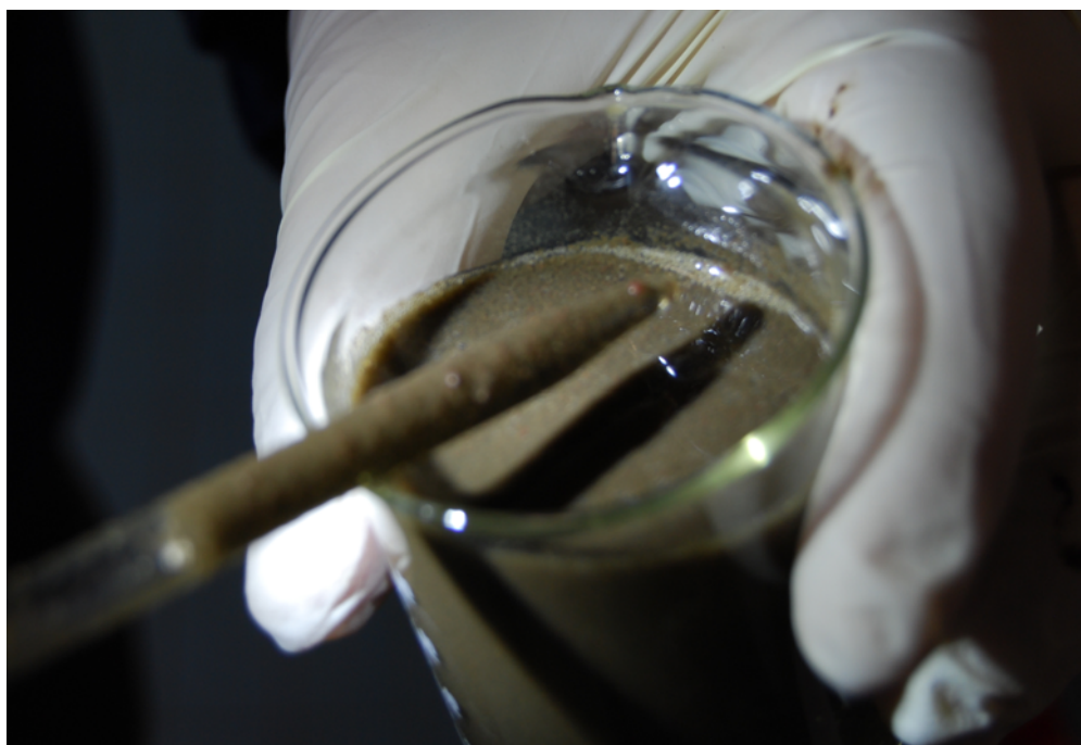
Kuva 33. Syöttölietteestä otettu näyte, jossa havaittavissa muutama punainen anammox granula.
