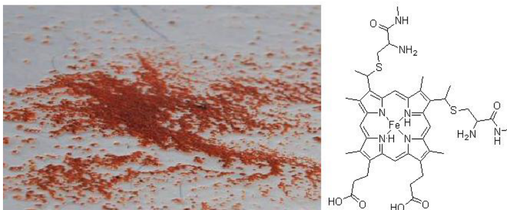
Kuva 13. Demon liete on väriltään punaisen ruskeaa ja partikkelikooltaan suurta.
