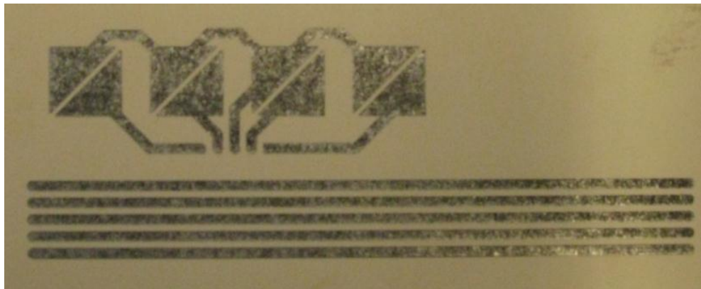
Kuva 24: Kapasitiiviset näppäimet ja johtimia.
