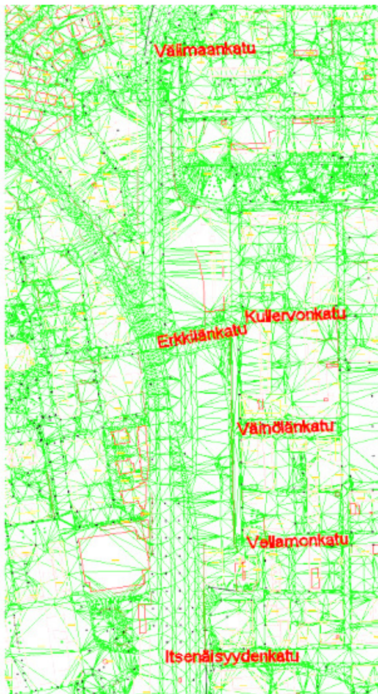
Kuva 4.8. Kaupunkimallin dwg-tiedosto ratapihalta. Maanpinnan kolmioverkko on esitetty kuvassa vihreillä kolmioilla. Nykyiset rakennukset on esitetty punaisen eri sävyillä. (Coloma 2012. [kaupunkimalli]). Kuvaan on lisätty pohjoisnuoli sekä katujen nimiä.
