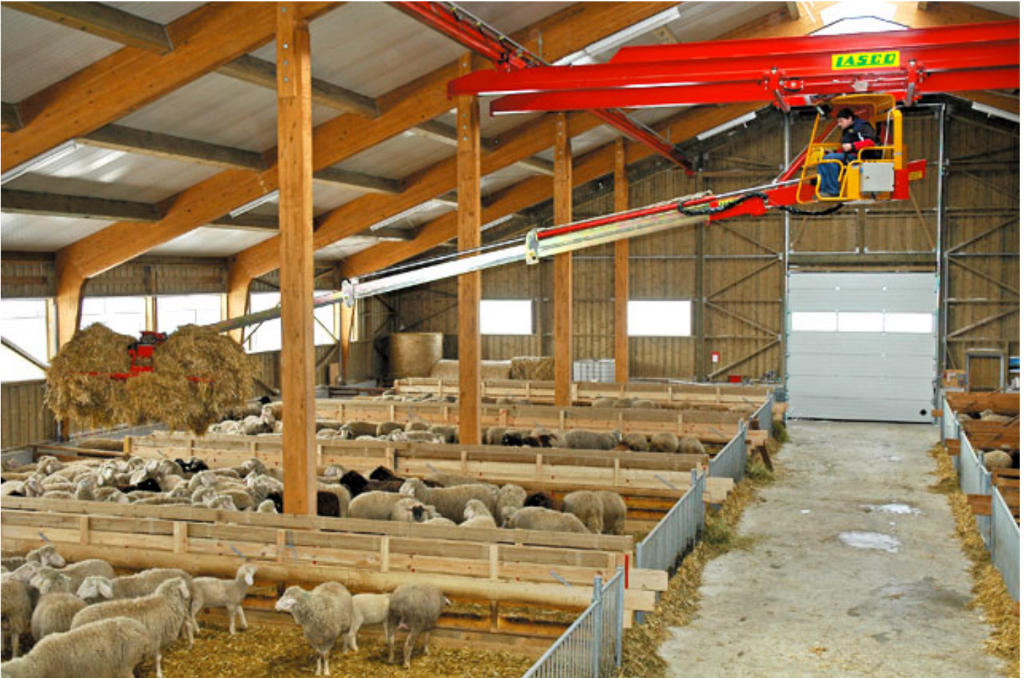
Kuva 5.7 Siltanosturi lampolassa Itävallassa
