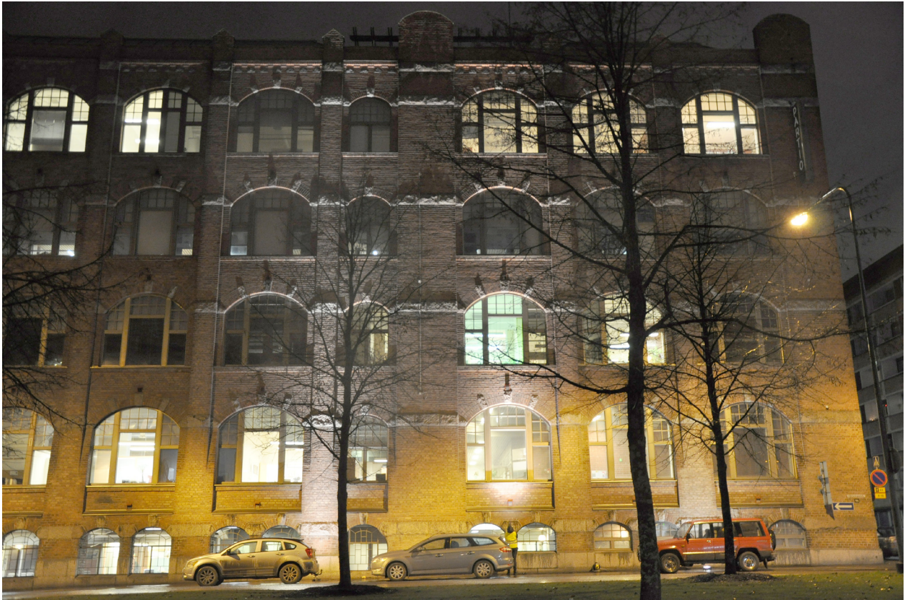
Kuva 74. Klingendahlin koevalaistusta. Vasemmalla näkyvä valo on 150 wattisesta monimetallivalaisimesta, jossa on valokiilaa pehmentävä silkkikalvo. Keskellä 70 watin monimetallivalaisin. Kummassakin valaisimessa valon värilämpötila on korjattu vastaamaan noin 3000 kelviniä. Kolmas valaisin oikealla on laajakiilainen 70 watin monimetallivalaisin. Valon värilämpötila oli 3500 kelviniä, mutta ei valonjaon vuoksi erottunut katuvalaistuksesta hyvin.
