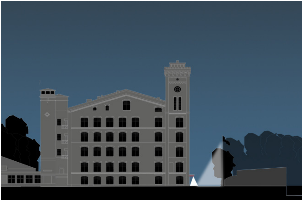
Kuva 95. Katutilan valaistus. Kevyen väylän valaistus toteutetaan seinävalaisimilla. Ajoväylälle sijoitetaan uudet monimetallivalaisimet.
