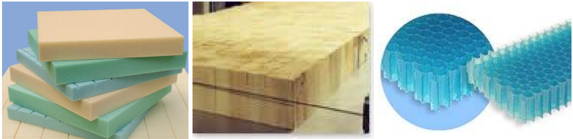
Kuva 5: Erilaisia ydinaineita vasemmalta oikealle: PVC-vahto, balsa ja PC-hunajakkenno [DIAB, CEL]
