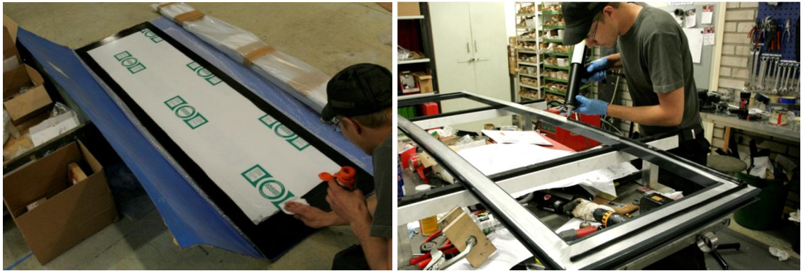
Kuva 14: Vasemmalla: primer-reunus ikkunassa ja sen aktivointi. Oikealla: liimamasan levitys
