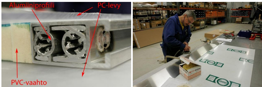
Kuva 17: Vasemmalla leikkauskuva testioven rakenteesta, oikealla kovapinnoitteen poisto PC-levystä
