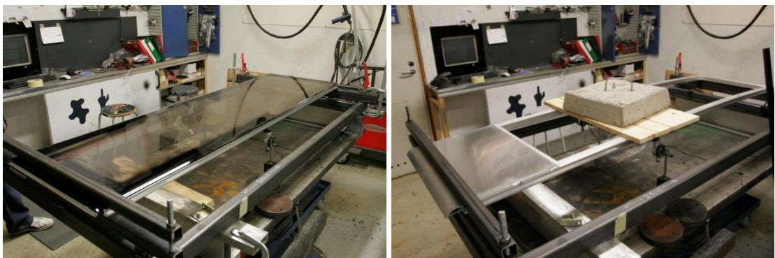
Kuva 6: Mittausjärjestely ovilehtien kolmipistetaivutukseen. Vasemmalla: lasillinen ovilehti. Oikealla: ovilehti rasituksessa
