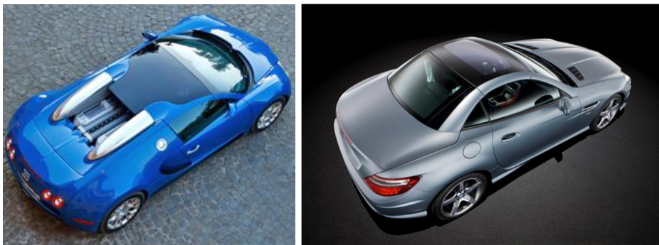
Kuva 1: Bugatti Veyron Grand Sport:n polykarbonaatista valmistettu targa-katto [Smith 2011] ja Mercedes Benz SLK Roadster:n kattoikkuna [BayNews 2011]
