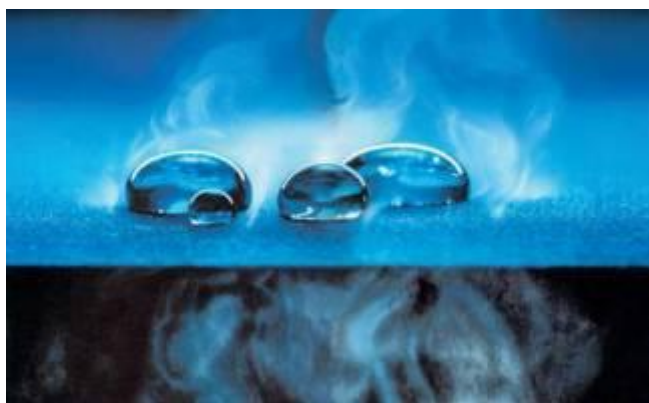
Kuva 11: Periaatekuva aluskatteen toiminnasta. Diffuusioavoin kalvo päästää lävitseen vesihöyryn, muttei nestemäistä vettä sen pintajännityksen johdosta [7].
