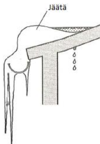
Kuva 1: Jääpuikkojen muodostumista räystäällä (alkuperäinen kuva lähteestä [2]).
