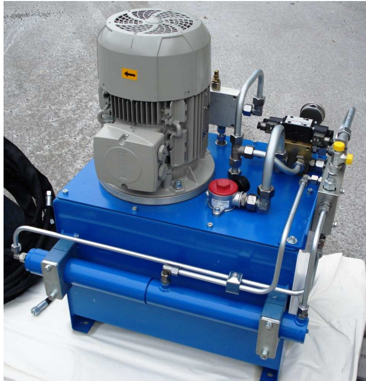
Kuva 6.4. Puristimen hydraulikoneikko. (Laatikainen 2011)
