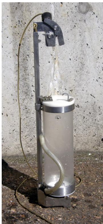
Kuva 1 Altaiden jätevesinäytteisiin käytetty Limnos-mallinen näytteenotin
