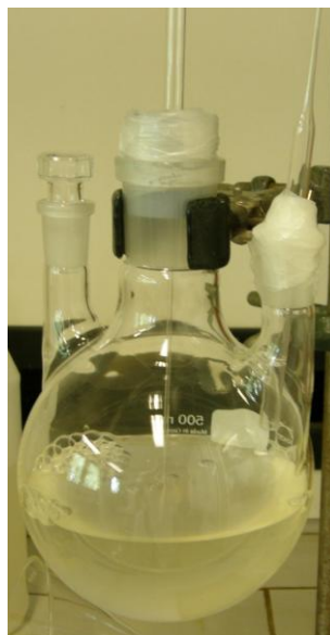
Kuva 3 Ilmastuskolvi, jossa keskeltä syötetään ilmaa ja oikeanpuolimmaisesta kaulasta ilma pääsee poistumaan
