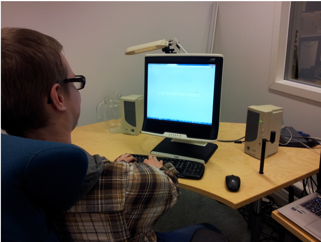
Kuva 13: Testitilanne Tampereen yliopiston katselaboratoriossa, katseenseurantalaiteistona Tobii T60.
