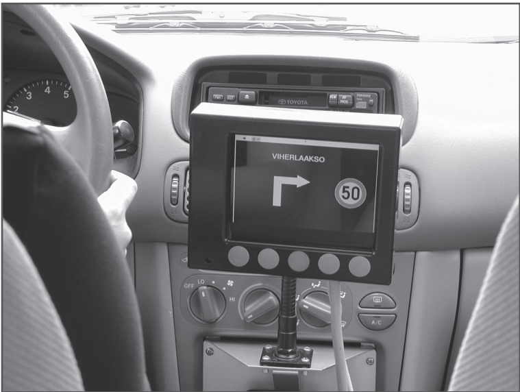
Kuva 2. Nopeudensäätöjärjestelmä henkilöautossa. (Lähde: VTT.)
