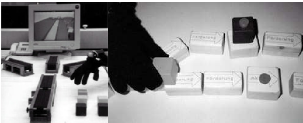
Kuva 2. Real Reality -järjestelmä liukuhihnojen mallintamiseen ja sääntöjen luomiseen [Schäfer et al. , 1997].
