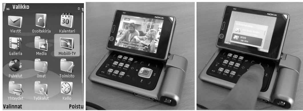
Kuva 5. Vasemmalla – MobiiliTV:n katsominen aloitetaan käynnistämällä MobiiliTV-sovellus puhelimen valikosta. Keskellä – MobiiliTV-sovellus käynnissä. Oikealla – MobiiliTV:ssä kanavan vaihtaminen sujuu selausnäppäintä käyttäen tai numeroilla.
