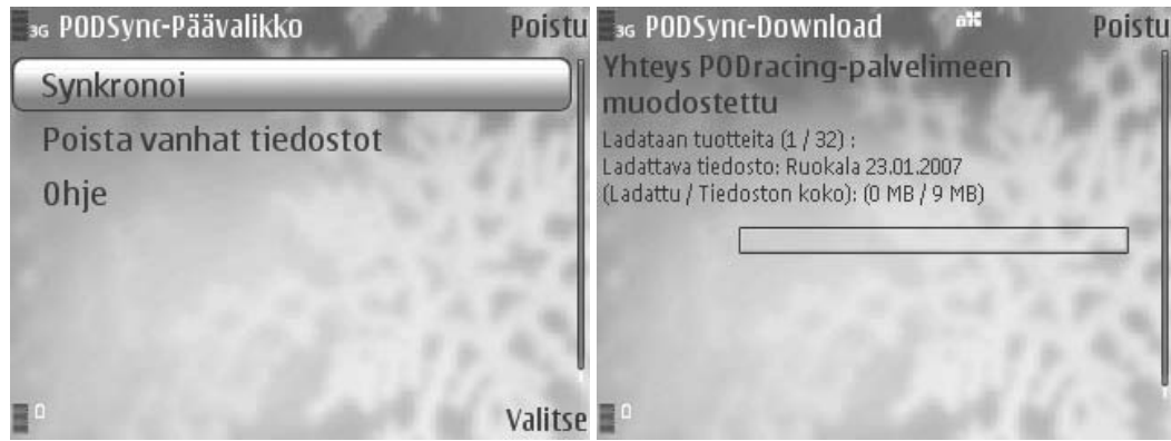
Kuva 18. Podsync-sovelluksen käyttöliittymä. Vasemmalla on sovelluksen päävalikko ja oikealla parhaillaan tapahtuvan latauksen näkymä.
