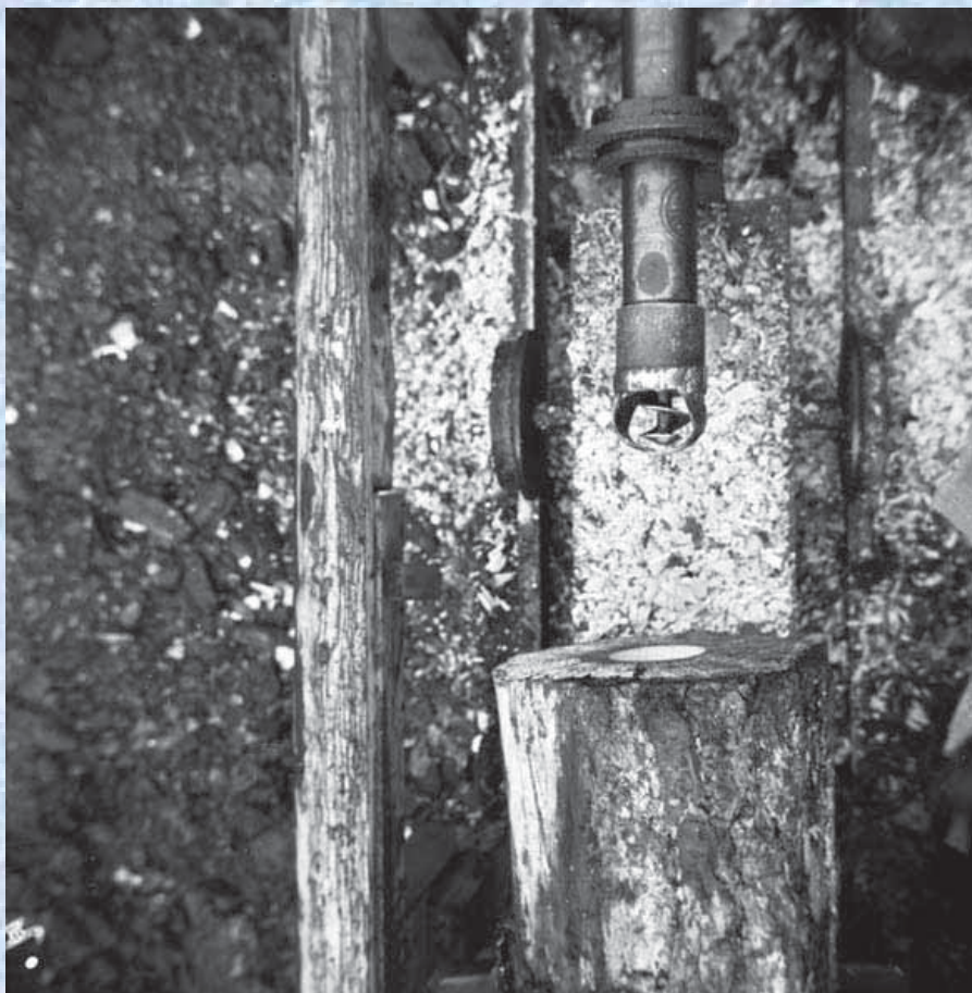
Puisien vesijohtoputkien valmistus vaati erityistä ammattitaitoa. Tätä taitoa löytyi Jurvasta. Kuvat otettu 23.9.1948. (Tampereen museot)
