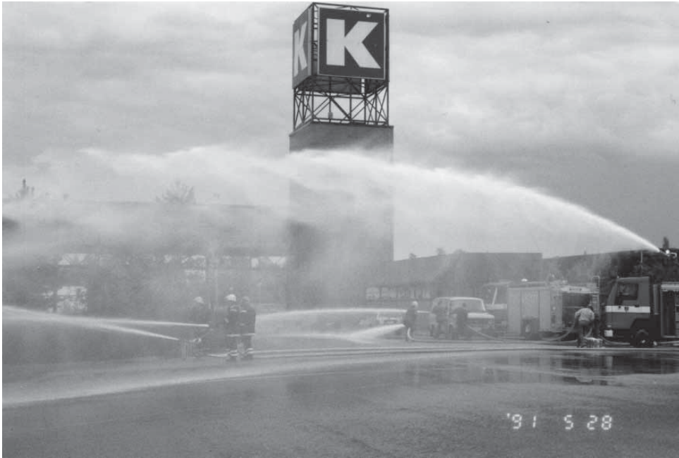
Kuva. Keskon keskusvaraston palovesiaseman kokeilussa saatiin ihailtavaksi ko-meat vesisuihkut toukokuussa 1991. Saatu antoisuus oli 8000 litraa minuutissa. (Vantaan Vesi 1991)
