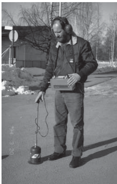
Kuva 9.8 Olli Ihanainen kuuntelemassa mahdollisia vuotoja maaliskuussa 1994. (Vantaan Vesi 1994)
