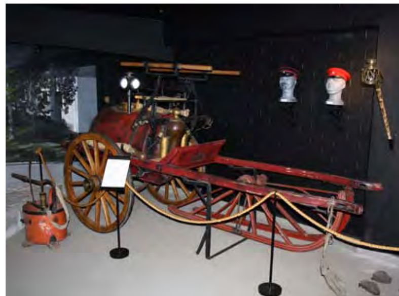
Ensimmäinen varsinainen sammutusyksikkö hankittiin Hämeenlinnaan vuonna 1907. Helsingin palopäällikkö Gösta Waseniuksen keksintö ns. tynnyriruisku edusti aikansa huipputekniikkaa. Kaupungin vuokra-ajureilla oli päivystysjärjestelmä, jota noudattaen ruisku haettiin "Pruuttahuoneelta" Sibeliuksen puiston alakulmasta ja vietiin palopaikalle. Talven varalle olivat jalakset. (HS-Vesi)
