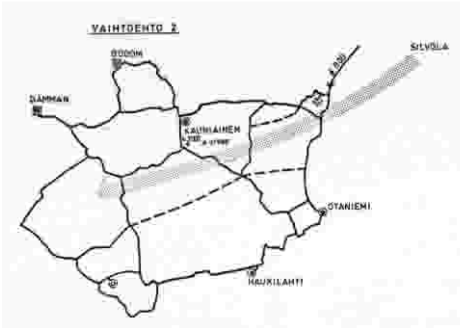
Kuva 9.3. Espoon omatoiminen pitkän tähtäimen vaihtoehto olisi ollut Päijännetunnelin jatkaminen Bodomin eteläpuolelle ja ns. Oittaaan laitoksen rakentaminen. Kuvassa Päijänteen tunnelille on hahmotettu jatkotunneli Helsingin Silvolasta Kauklahteen, jonne olisi rakennettu Espoon oma vedenkäsittelylaitos. Tässä vaihtoehdossa raakavesitunnelin ja vesilaitoksen lisäksi oli piirretty puhtasvesijohto Espoon itäosiin. (Sipi 1974)
