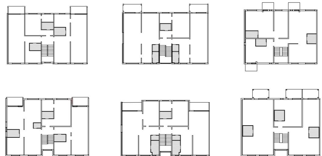
Kuuden korttelin yleisiä lamelleja. Kaaviomaiset pohjapiirroksat, joissa esitetty ulkoseinät, kantavat rakenteet ja porrashuone sekä märkätilat harmaalla.
