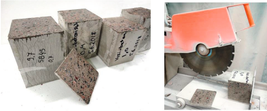
Kuva 17.1 Muoteista saadut betoninäytteet ja niiden katkaisu mittauksia varten. (Kuvat: Asp)
