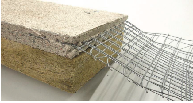
Kuva 7.3 Rappausverkon sijainti rappauksen keskellä. (Valokuva: Asp)
