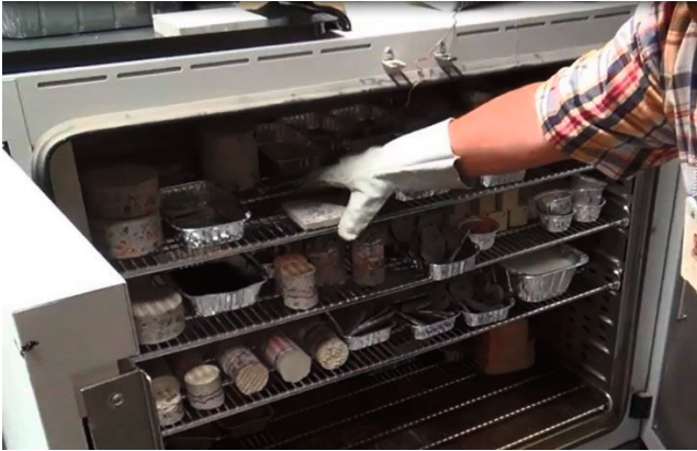
Kuva 17.2 Betoninäytteiden uunikuivaus. (Kuva: Asp)
