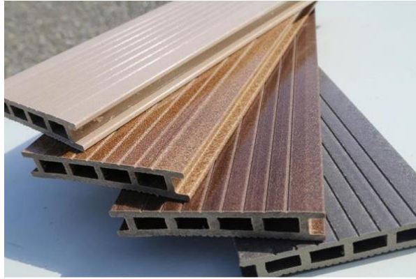
Kuva 1. Puumuovikomposiitista ekstruusiolla valmistettuja profiileja (Arsham Trading n.d.).
