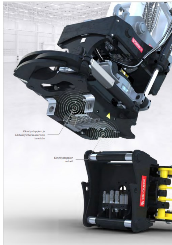
Kuva 12. Pikakiinnikkeen liittäminen työvälineeseen [37].
