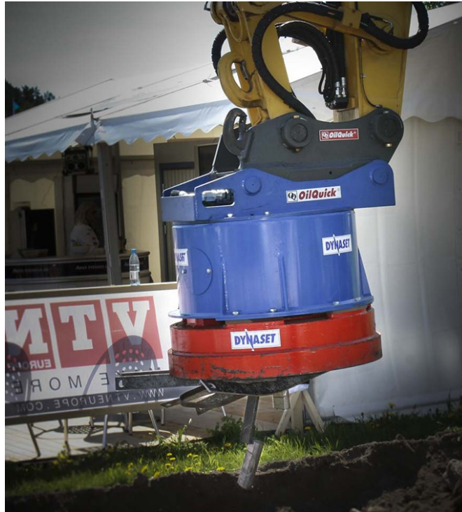
Kuva 24. HMAG Pro Hydraulimagneetti kiinni pikaliittimessä [30].
