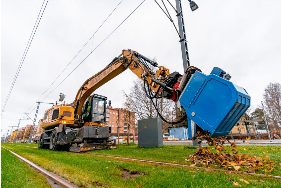
Kuva 25. HRVB Hydraulinen kierrätysimukauha kaivinkoneessa [33].
