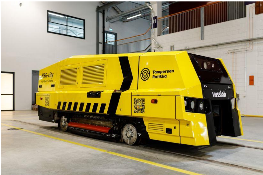
Kuva 9 HSG-City -hiontavaunu (Stenroos [Tiitola] 2020)
