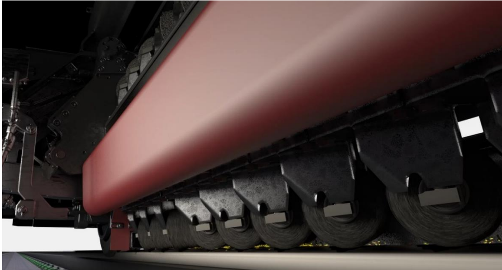
Kuva 10 High Speed Grinding, muokattu lähteestä (Vossloh AG 2023)
