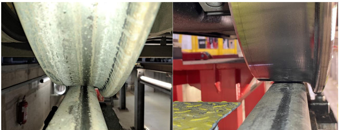
Kuva 8 Pyörän kehä ennen profilointia ja profiloinnin jälkeen
