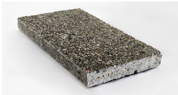
Kuva 111: Puretun oslolaisen hallintorakennuksen taltioitu ja dokumentoitu Naturbetong-julkisivuelementti.
