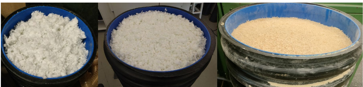
Kuva 4. Kuvassa on taulukon 1 materiaalit asennettuina koekappaleisiin. Vasemmalta katsottuna lasivilla 1, lasivilla 2 ja kutterinlastueriste.
