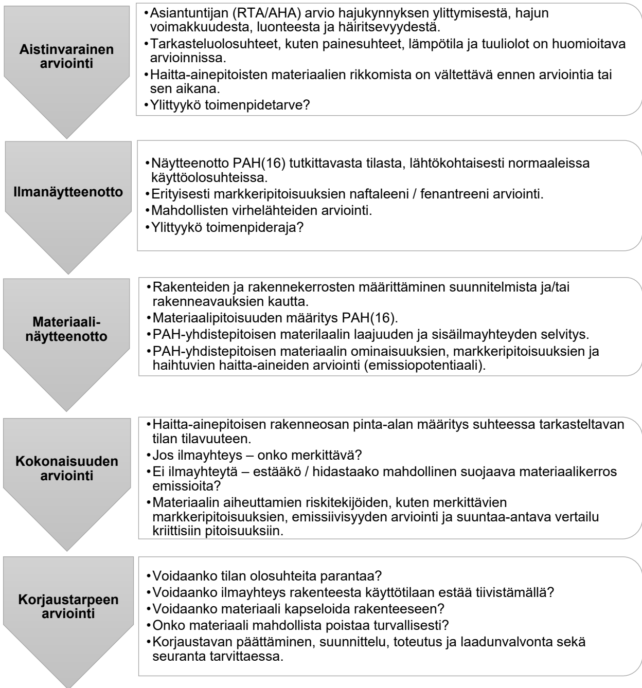
Kuva 4. Etenemismalli PAH-yhdisteitä sisältävien rakennusmateriaalien riskien arvioimiseen.
