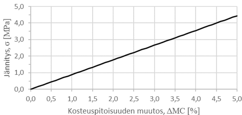
Kuva 1. Puun kosteuspitoisuuden ja muodonmuutoksen aiheuttaman jännityksen välinen yhteys.
