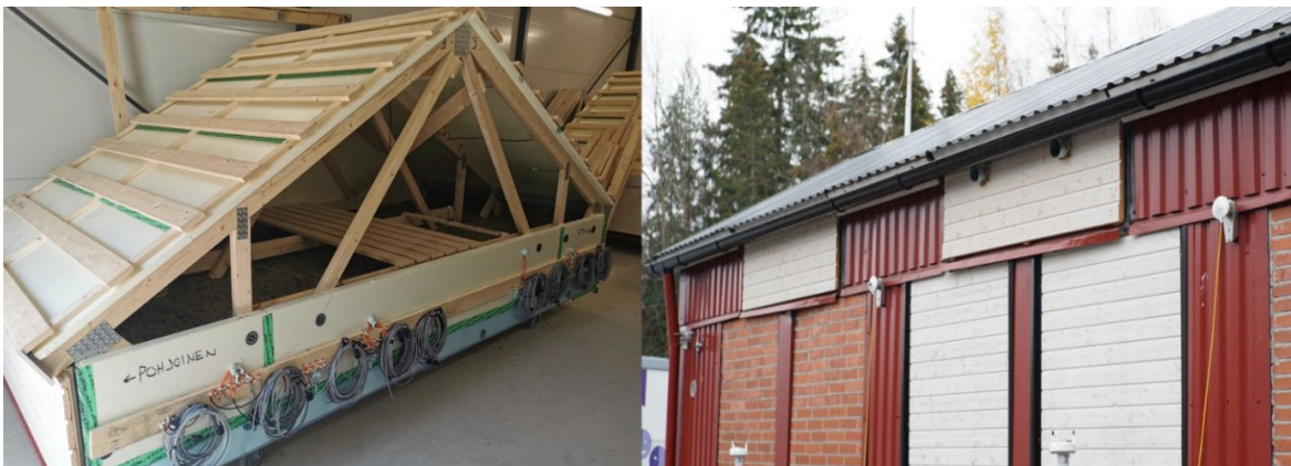
Kuva 2. Valokuva yläpohjakoerakenteesta ennen asentamista koerakennukseen (vasemmalla) ja valokuva koerakennuksesta (oikealla).
