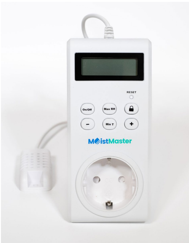
Kuva 1. MoistMaster® E10 LD kuivanapitosäädin. Säädin mittaa tilan lämpötilaa ja suhteellista kosteutta ja kytkee siihen liitettyyn lämmityslaitteeseen virran, kun suhteellinen kosteus ylittää sallitun raja-arvon. [4]
