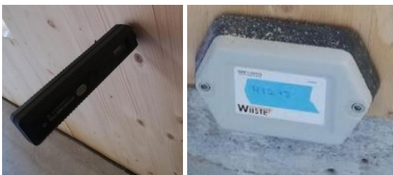
Kuva 1.a ja b. Gann Hydromette Compact S puunkosteusmittarilla (a) ja WM1-WAN-mittari (b).
