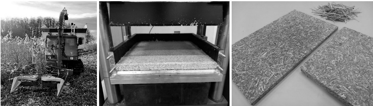
Kuva 2. Järviruo'on matka rannalta rakennuslevyksi.
