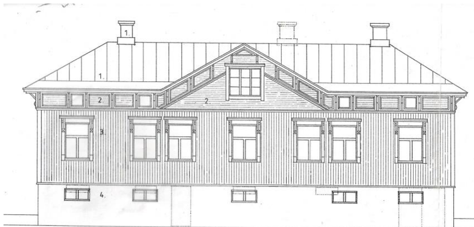
Kuva 6. Eteläinen julkisivu, rakennuspiirustuksista vuodelta 1991. Muuttuneen aukotuksen alkuperäinen sijainti esitetty katkoviivalla. (Marja Alastalo & Jorma Alastalo, 2023).
