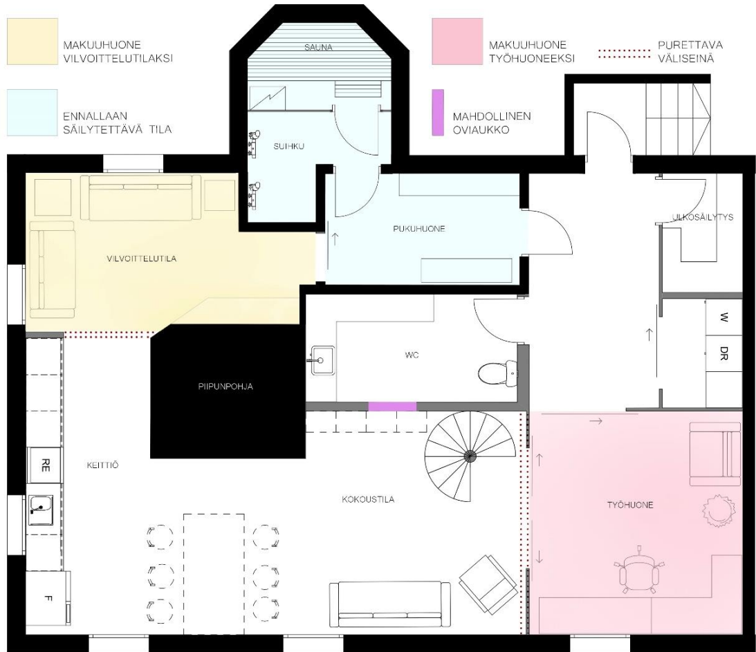
Kuva 19. Variaatio kuvasta 18. Makuuhuoneet muutettu työhuoneeksi ja vilvoittelutilaksi. Olemassa olevat seinät esitetty mustalla, rakennettavat väliseinät harmaalla.
