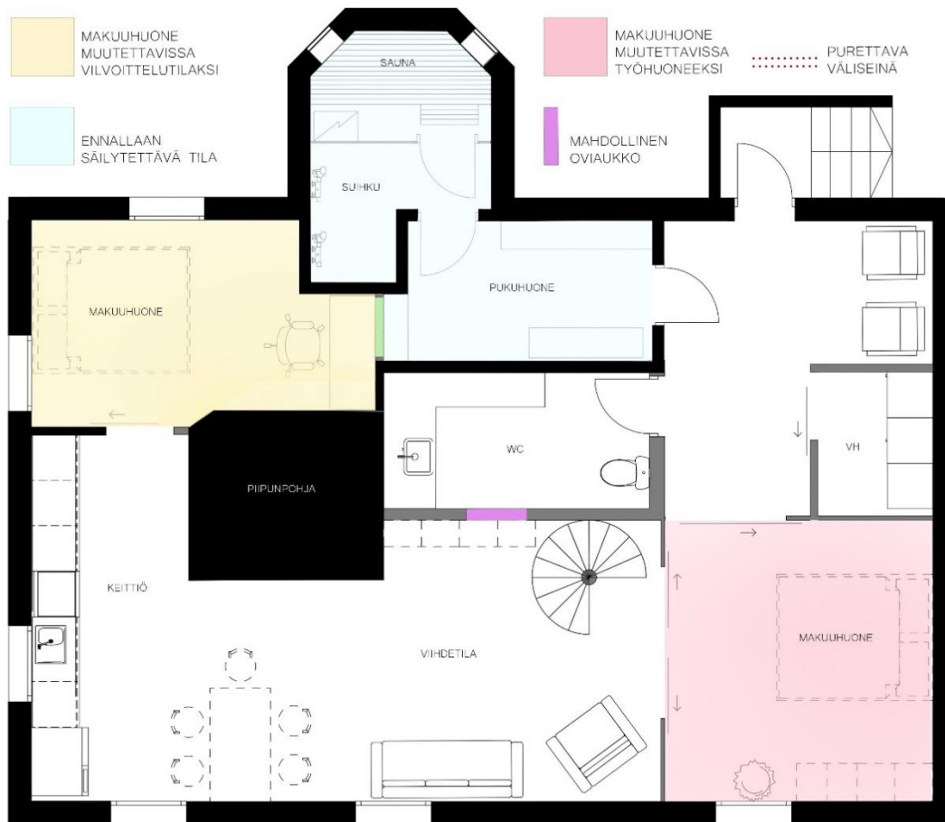
Kuva 18. Kellaritila pääkerroksen asunnon laajenuksena. Kaksi makuuhuonetta, wc-tilat, sauna- ja suihkutilat, pukuhuone, vilvoittelutila sekä vaatehuone. Olemassa olevat seinät esitetty mustalla, rakennettavat väliseinät harmaalla.
