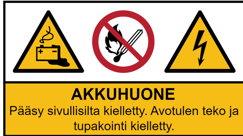
Kuva 35. Akkuhuoneen standardien mukainen merkintä. Muodostettu lähteen [72] avulla.
