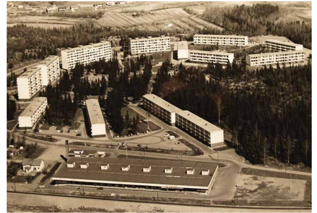
Kuva 6: Keuhkokaavion ideaalimallin mukainen lähiöalue Tesoman Ristimäki Tampereella. Rakennukset kiertyvät maastonmuotojen mukaan kohti Ristikukkulan huippua. Autoliikenne ja pysäköintialueet ovat rakennusten ulkokehällä, ja alueen keskelle on jätetty viheralueeksi runsaasti metsää ja avokallioita (Kuva: Aarre Mattisen valokuvakokoelma / Rakennusliike Mattinen & Niemelä Oy, teoksessa: Pöyry & Tampere 2010, 1).
