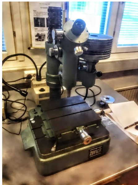
Kuva 17. Murtositkeysmittauksessa käytetty Zwick-kovuusmittauslaitteisto.
