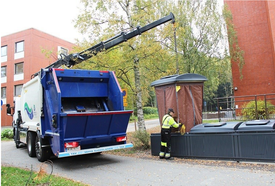
Kuva 7. Syväkeräysastian tyhjennys jäteauton puominosturilla. Nosturin koukku on kiinnitetty syväkeräysastian nostolenkkiin. (Kuvan lähde: Molok, muokattu kuvan omistajan pyynnöstä, lupa kuvan käyttöön myönnetty)
