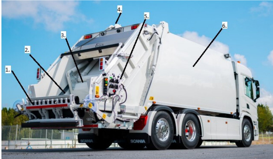
Kuva 5. Takaa lastattavan pakkaavan jäteauton olennaiset osat: 1. Astiahissi 2. Jäteauton keräin 3. Jätteen pakkaaja 4. Vinssi pikakonttien tyhjennystä varten 5. Pakkaajan ja jätteastian ohjaimet 6. Jäteauton jätetila. (Kuvan lähde: NTM, muokattu, lupa kuvan käyttöön myönnetty)
