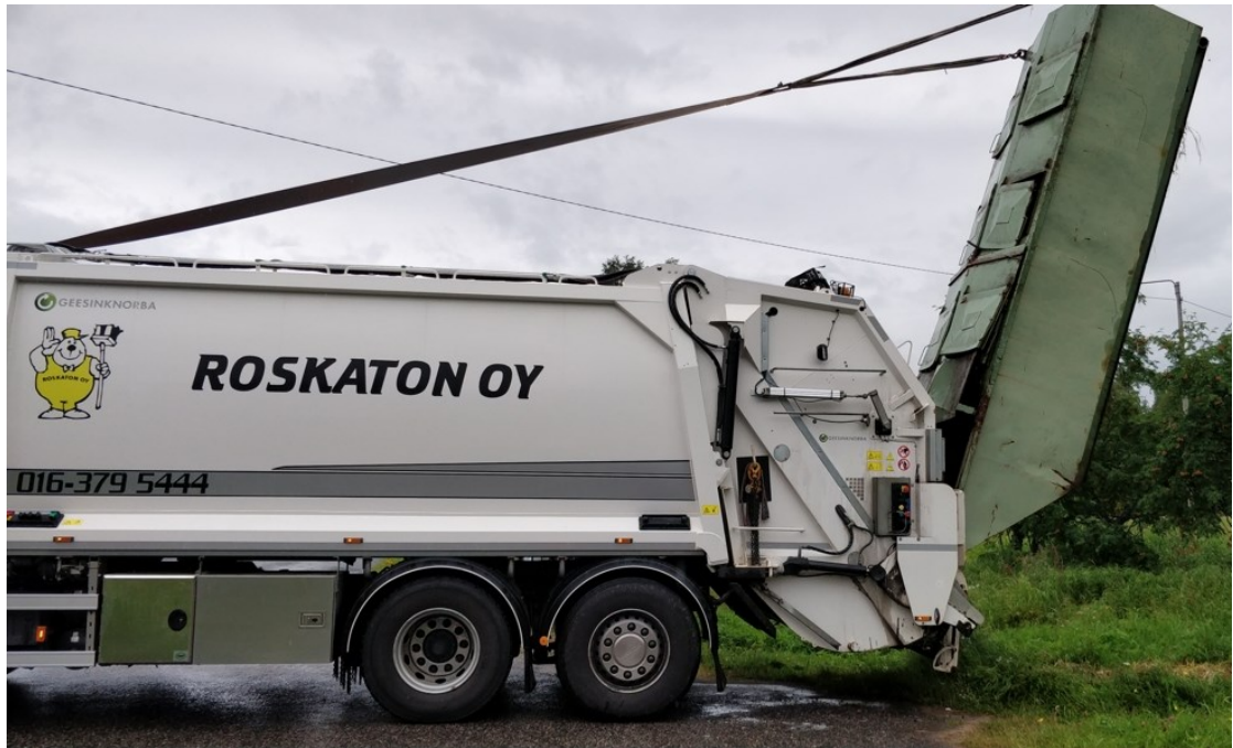
Kuva 8. Pikakontin tyhjennys. Pikakontti on kiinni jäteautossa sen etuosan kiinniketapeilla ja sitä nostetaan sen takaosasta jäteauton vinssillä. (Kuvan lähde: Roskaton Oy, lupa kuvan käyttöön myönnetty)
