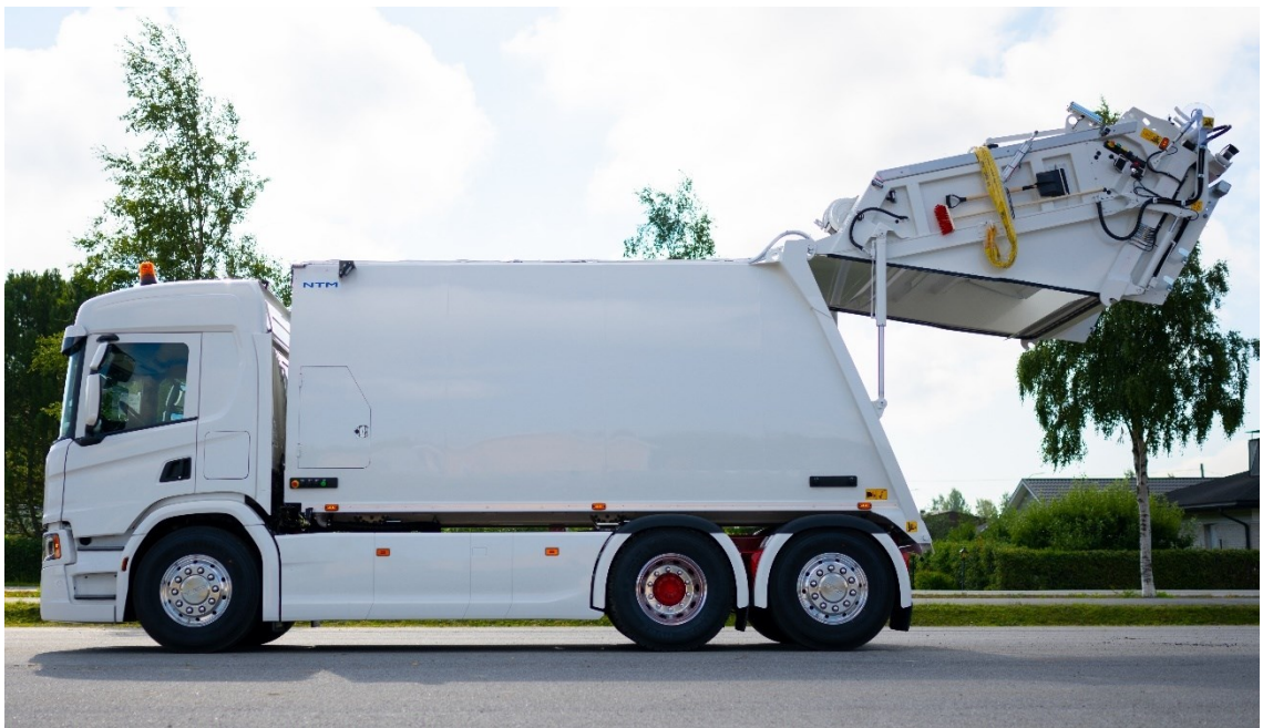
Kuva 6. Jäteauto peräportti on nostettu ylös, jotta siirtolevy pystyisi työntämään jätteen ulos jätetilasta. (Kuvan lähde: NTM, lupa kuvan käyttöön myönnetty)
