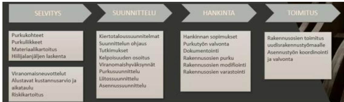
Kuva 11. Uudelleenkäytettävien rakennusosien hyödyntämisprosessi (Kiertotalouden konsepti).
