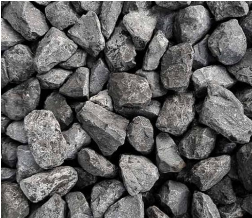
Kuva 3. Betonin runkoaineena käytettävää kalliomurskettä (Kalliomurske)
