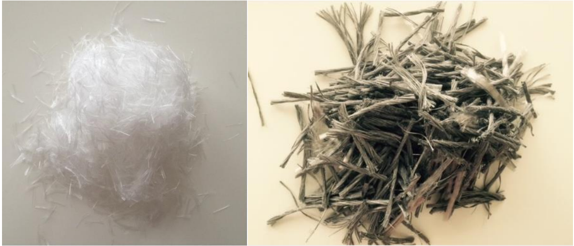
Kuva 4. Betonissa käytettäviä mikrokuituja (vasen) ja makrokuituja (oikea) (Rudus.fi).
